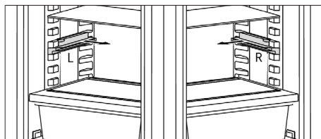
obr. 8.7 Vyjmutí montážních lišt pro víceúčelový tácek
