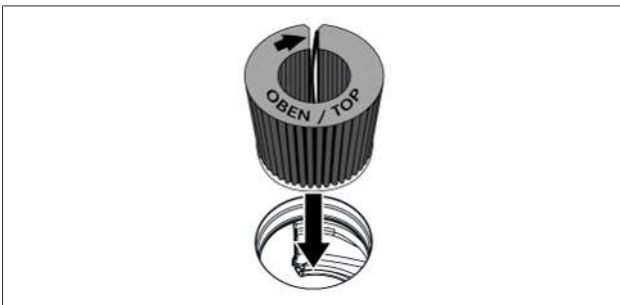
Kuva 7.6 Hajusuodattimen asettaminen tuloaukkoon
