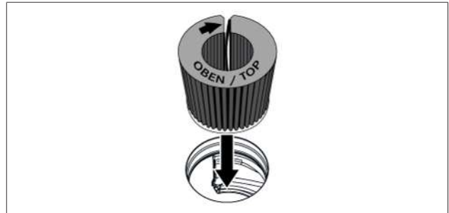
Fig. 7.6 Colocación del filtro de olores en la abertura del extractor
