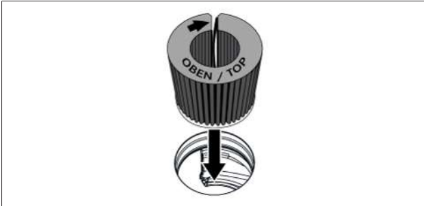
Bild 7.6 Sätta in luktfiltret i ångsugsöppningen
