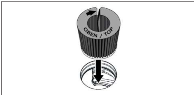
Sl. 7.6 Vstavljanje filtra z ogljem v odprtino za odvod zraka
