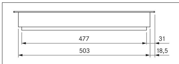
Fig. 3.4 PKT11 dimensiones del aparato vista lateral
