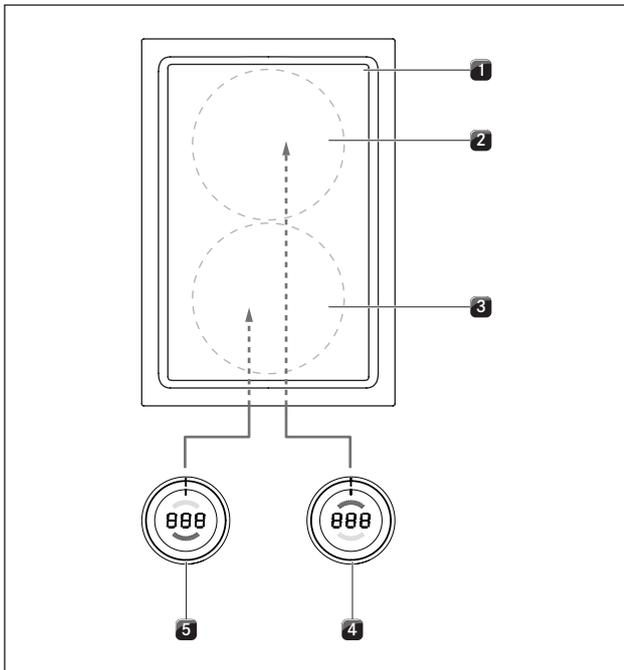
Fig. 5.20 Conexión de las zonas de cocción con montaje girado 180°
