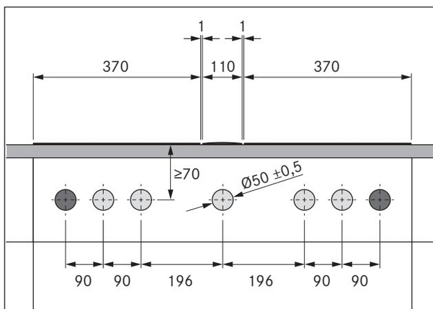
Fig. 5.10 Perforaciones en el frontal con 2 placas de cocción y 1 extractor de superficie
