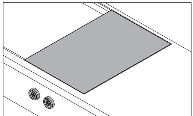
Fig. 5.7 Mandos selectores y placa de cocción montadas
