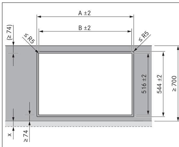
Fig. 5.3 Medidas del recorte para montaje enrasado
