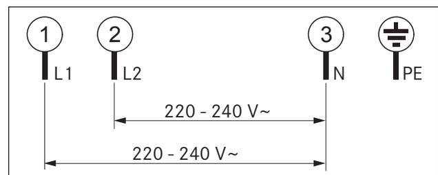
Fig. 5.21 Esquema de conexión bifásica
