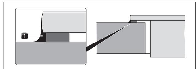
Fig. 5.16 Silicona de sellado para montaje superpuesto
