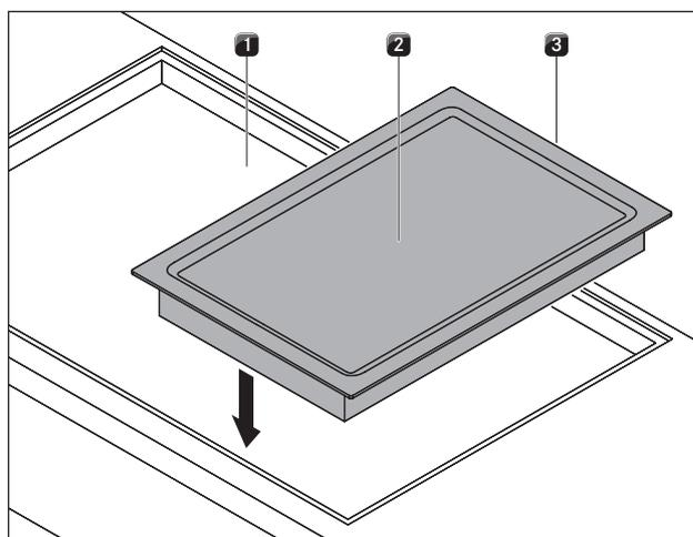
Fig. 5.12 Colocación de la placa de cocción
