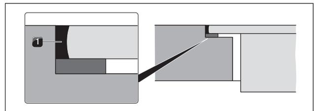
Fig. 5.15 Silicona de sellado para montaje enrasado
