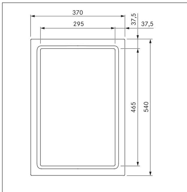
Fig. 3.2 PKT11 dimensiones del aparato vista en planta
