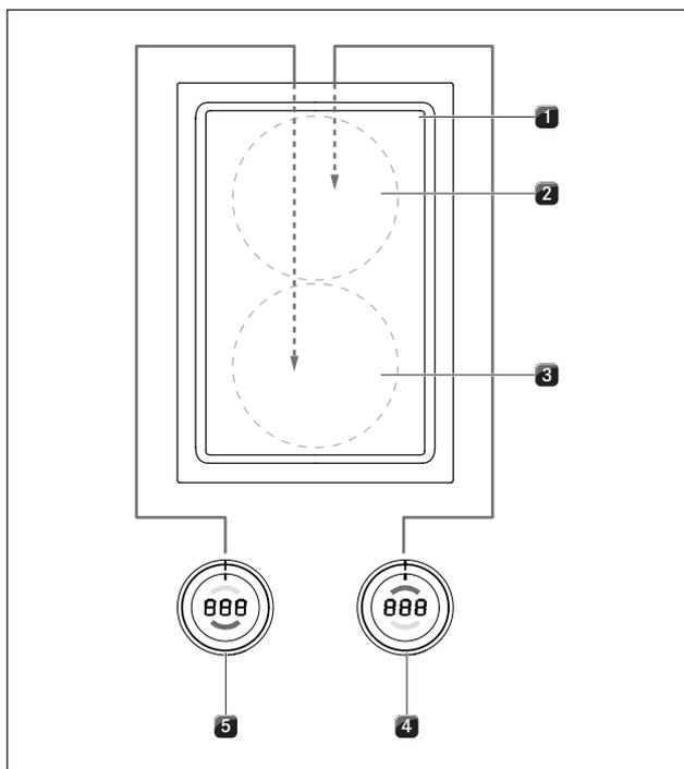
Fig. 5.19 Raccordement standard des zones de cuisson
