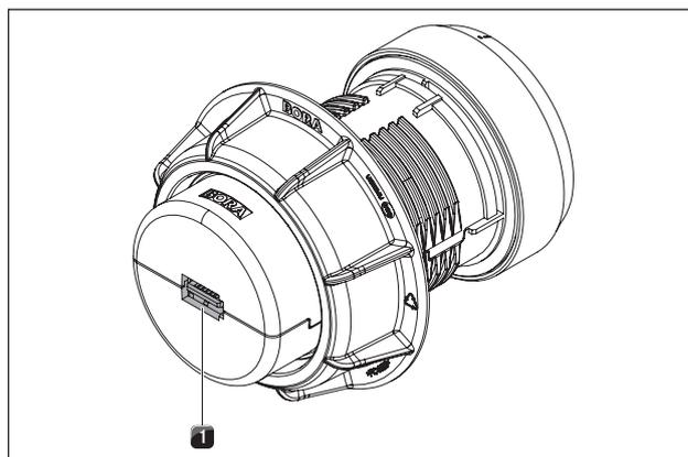
Fig. 5.17 Connecteur du bouton de commande à l'arrière
