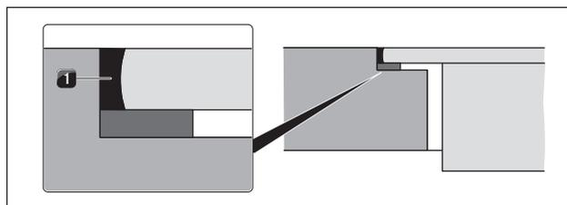
Fig. 5.24 Joint en silicone en montage affleurant
