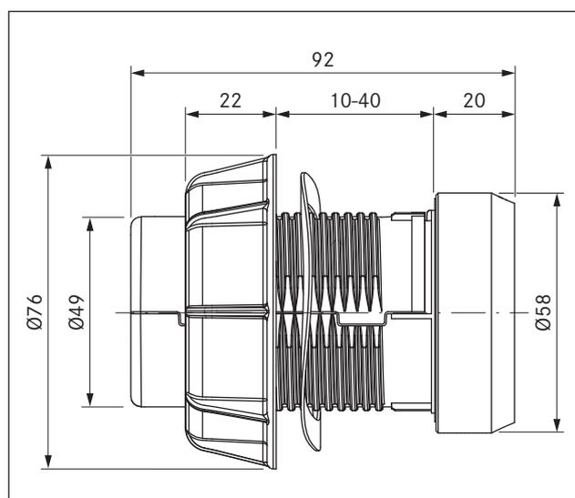
Fig. 3.1 Dimensions du bouton de commande
