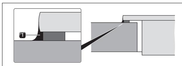
Fig. 5.25 Joint en silicone en montage en saillie
