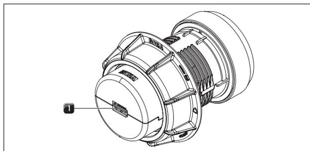
Fig. 5.19 Lato posteriore manopola di comando con connessione
