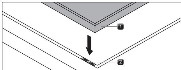
Fig. 5.17 Piano cottura e pannelli di compensazione altezza
