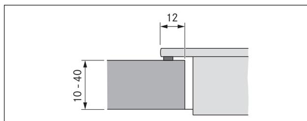
Fig. 5.8 Misura d'appoggio per montaggio in battuta
