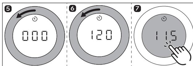
Fig. 6.15 Girare l'anello della manopola in senso antiorario
