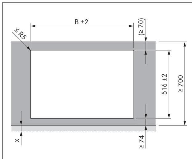
Fig. 5.7 Dimensioni intaglio per montaggio in battuta
