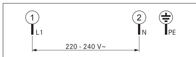
Fig. 5.24 Schema di collegamento monofase
