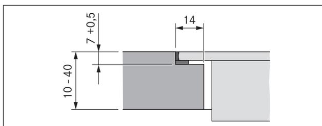
Fig. 5.6 Dimensioni dell'incassatura per montaggio a filo piano
