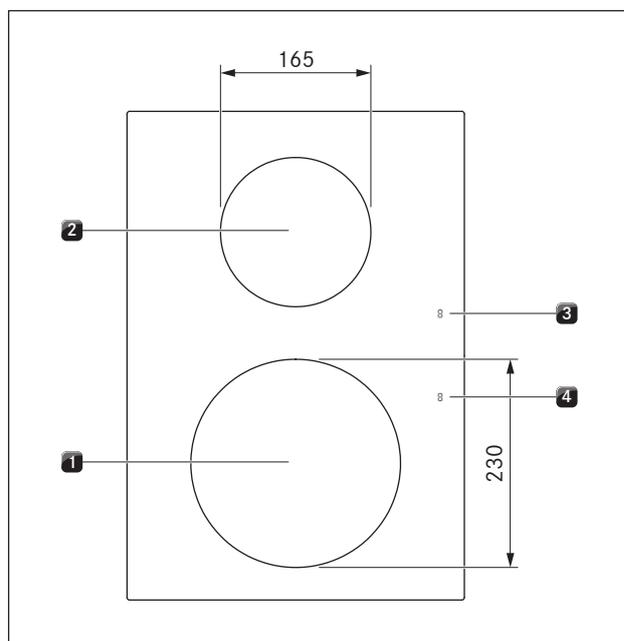
Fig. 4.5 Montaggio piano cottura PKI3 e dimensioni delle zone cottura
