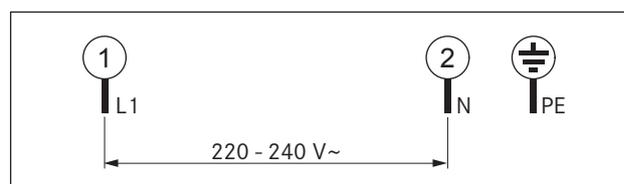
Fig. 5.24 Schéma de raccordement 1 phase
