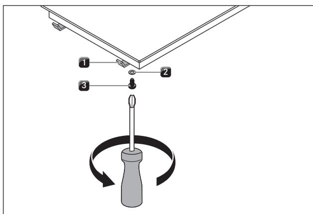
Fig. 5.18 Pattes de fixation
