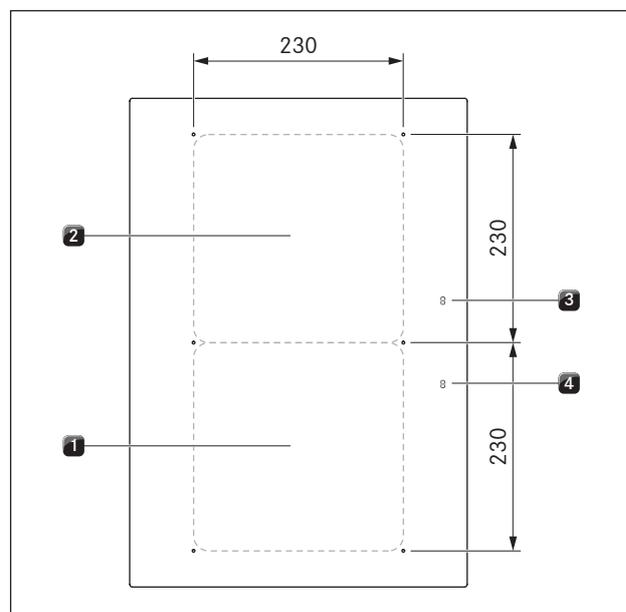
Fig. 4.5 Composition de la table de cuisson PKFI3 et dimensions des zones de cuisson
