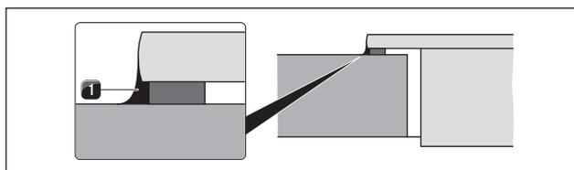
Fig. 5.26 Joint en silicone en montage en saillie
