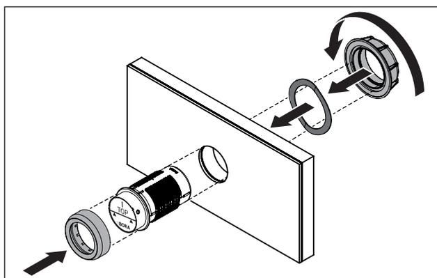
Fig. 5.14 Montage du bouton de commande
