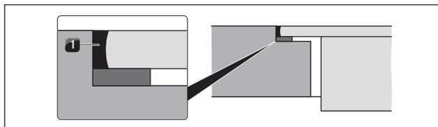
Fig. 5.25 Joint en silicone en montage affleurant
