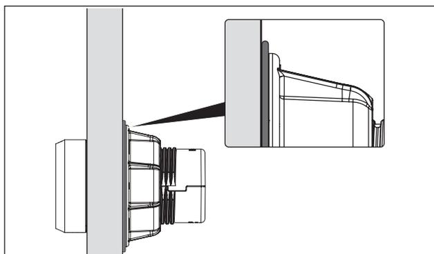
Fig. 5.15 Ressort ondulé en fin de montage
