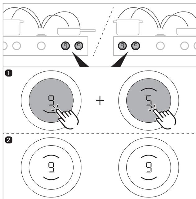
Fig. 6.8 Réglage du niveau de puissance d'une zone de cuisson
