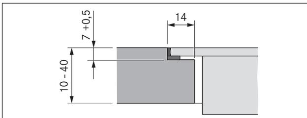
Fig. 5.6 Dimension de rainure pour montage affleurant
