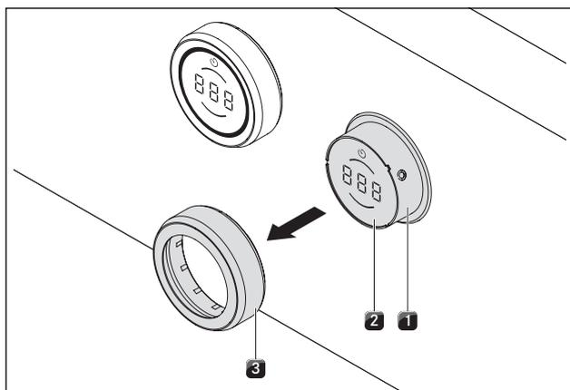
Fig. 7.1 Retrait de la bague du bouton rotatif
