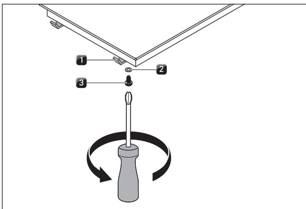
Fig. 5.18 Pattes de fixation
