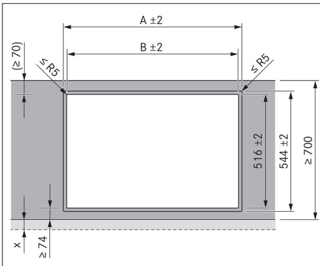
Fig. 5.5 Dimensions de découpe pour montage affleurant
