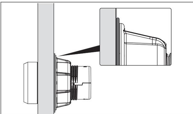
Fig. 5.15 Ressort ondulé en fin de montage
