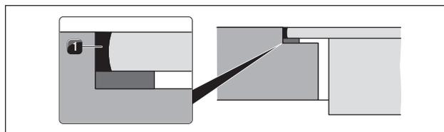
Fig. 5.27 Joint en silicone en montage affleurant
