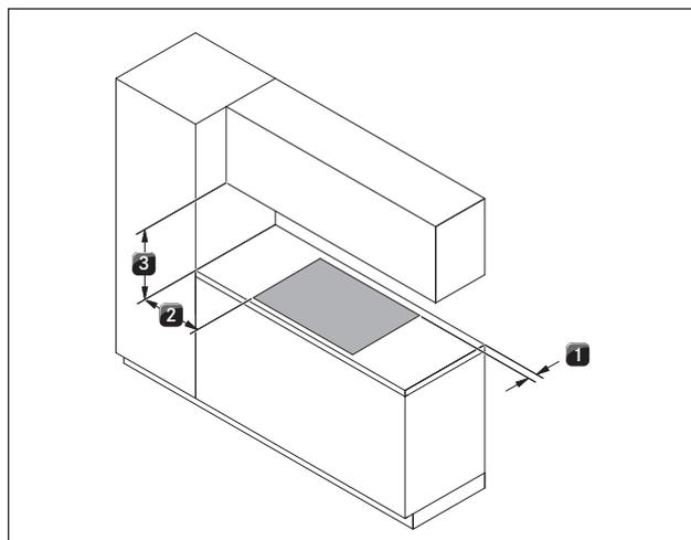
Fig. 5.19 Distances minimales en montage à 180°
