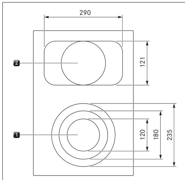
Fig. 4.6 Composition de la table de cuisson PKCB3 et dimensions des zones de cuisson
