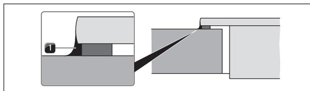
Fig. 5.28 Joint en silicone en montage en saillie
