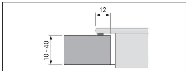
Fig. 5.8 Cote d'appui pour montage en saillie
