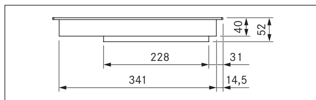
Ilustracja 3.3 PKI11, wymiary urządzenia, widok z przodu
