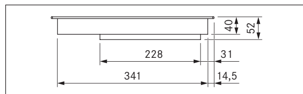
Prikaz 3.3 PKI11 dimenzije uređaja, prikaz srijeda
