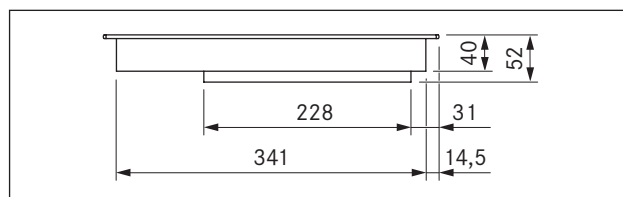
Kuva 3.3 Laitemitat PKI11 kuva edestä
