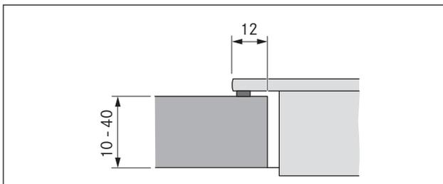
Abb. 5.6 Schnitt Aufsatzmontage
