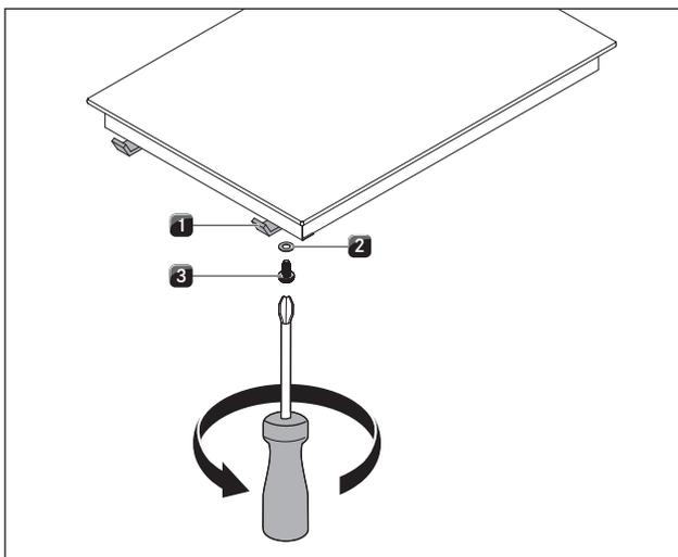
Abb. 5.14 Befestigungsklammern
