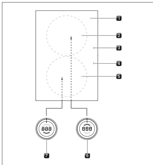
Fig. 5.19 Raccordement standard des zones de cuisson
