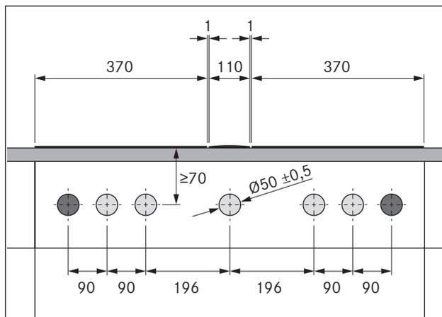
Fig. 5.10 Perçage de bandeau pour 2 tables de cuisson et 1 dispositif d'aspiration
