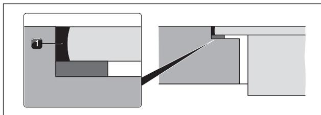
Fig. 5.15 Pâte de silicone pour montage affleurant
