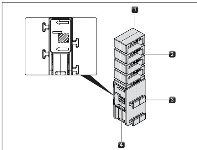
Fig. 6.12 Grampo de montagem lado esquerdo (montagem sobreposta)
