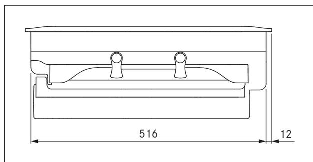
Fig. 3.7 PKAS, PKASAB dimensões do aparelho vista lateral
