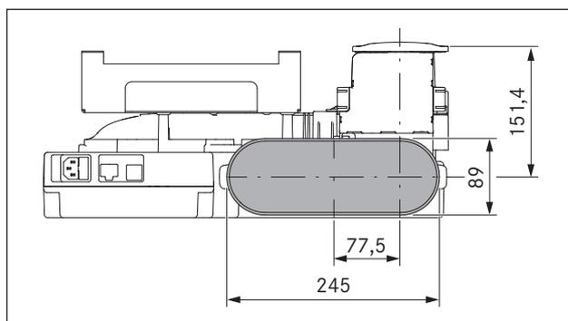
Fig. 6.18 Medidas de ligação de conduta PKAS, PKASAB
