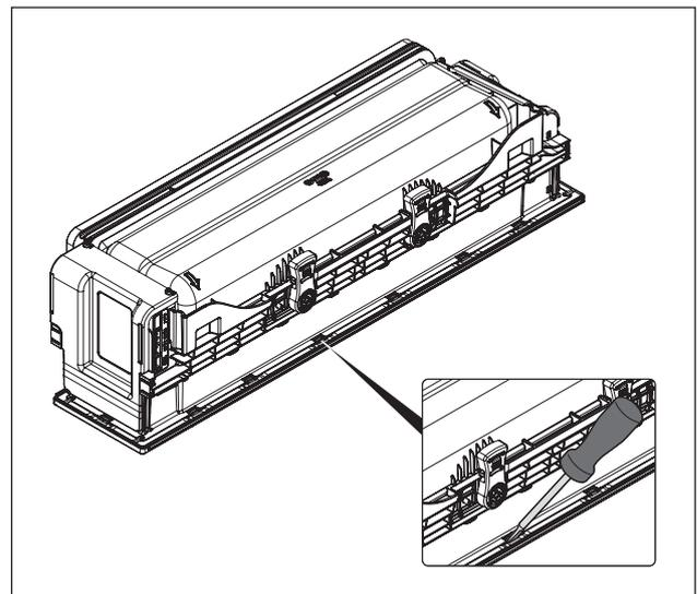
Fig. 6.29 Desmontar a estrutura de cobertura
