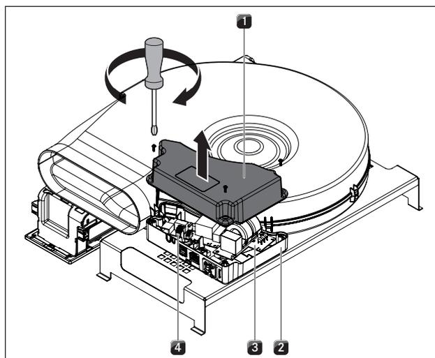
Fig. 6.37 Abrir a tampa da unidade de comando
