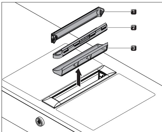
Fig. 8.2 Desmontagem dos componentes do filtro de gordura
