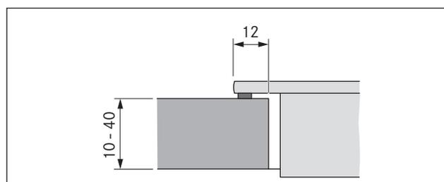
Fig. 6.6 Vista em corte montagem por sobreposição
