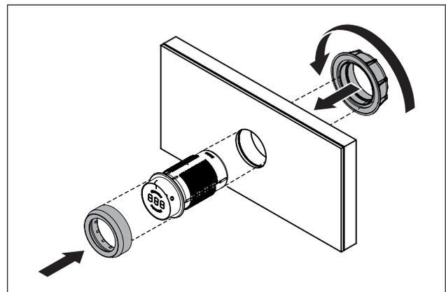
Fig. 6.23 Montar o comando seletor
