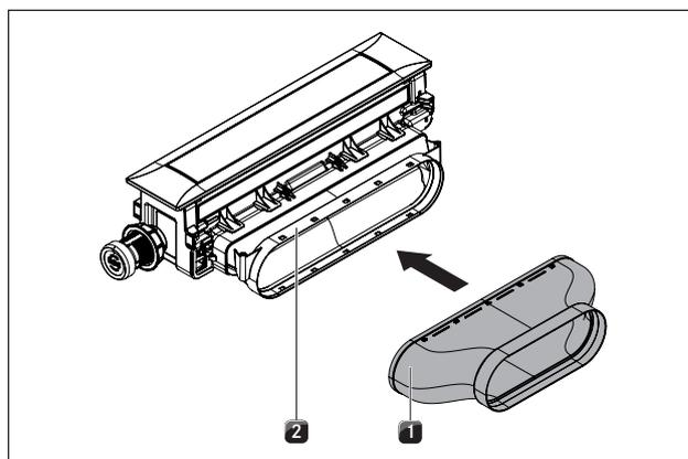
Fig. 6.26 Montar o elemento de conduta direito
