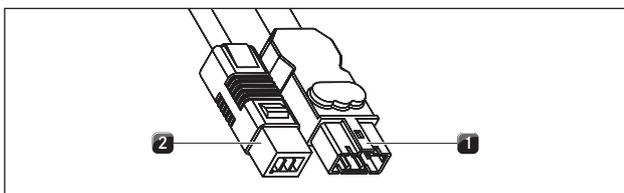
Fig. 6.48 Ficha de ligação do ventilador de rodapé
