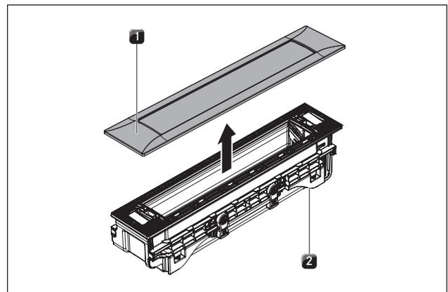
Fig. 6.30 Desmontar a estrutura de cobertura
