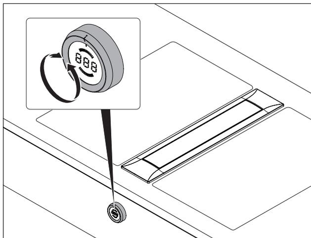
Fig. 7.3 Desligação do extrator de superfície
