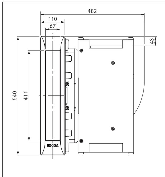
Fig. 3.1 PKA dimensões do aparelho vista de cima
