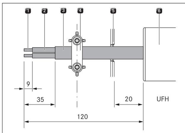
Fig. 6.40 Comprimentos de descarte e posição de montagem do cabo de ligação
