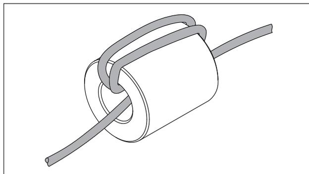
Fig. 6.39 Enrolar o cabo de ligação 3 vezes em volta da manga de ferrite
