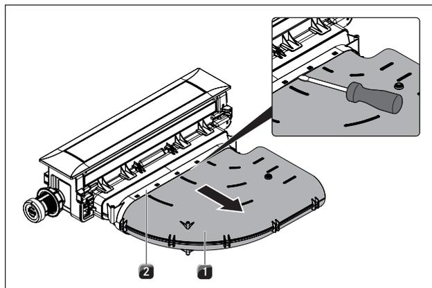
Fig. 6.25 Desmontar o elemento de conduta angular
