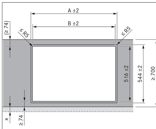
Fig. 6.3 Medidas de recorte, montagem à face
