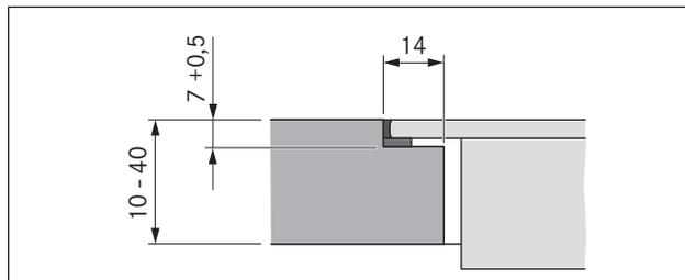
Fig. 6.4 Medida de recesso para montagem à face
