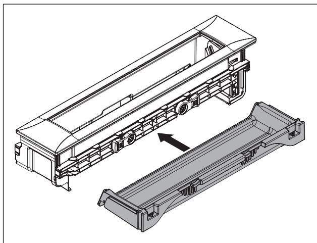
Fig. 8.6 Montagem da cubra de manutenção
