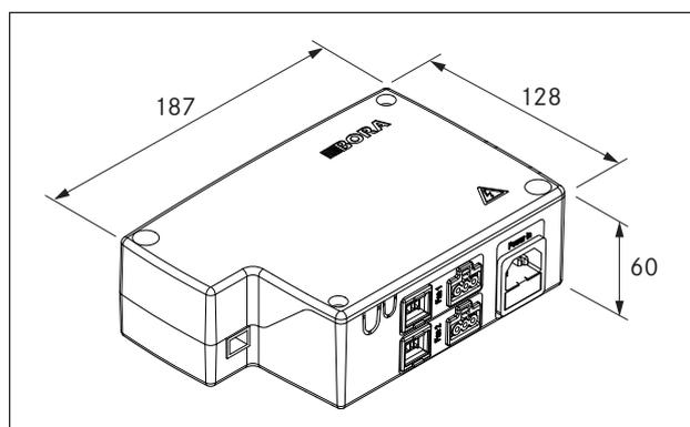
Fig. 3.4 Medidas do aparelho unidade de comando Universal
