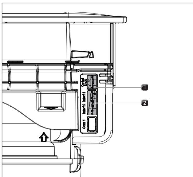
Fig. 6.44 Ligações laterais no extrator de superfície
