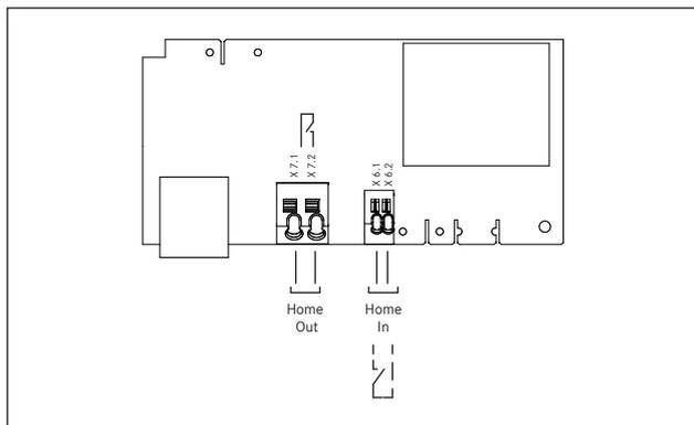
Fig. 6.41 Esquema de ligações dos contactos de corte externos
