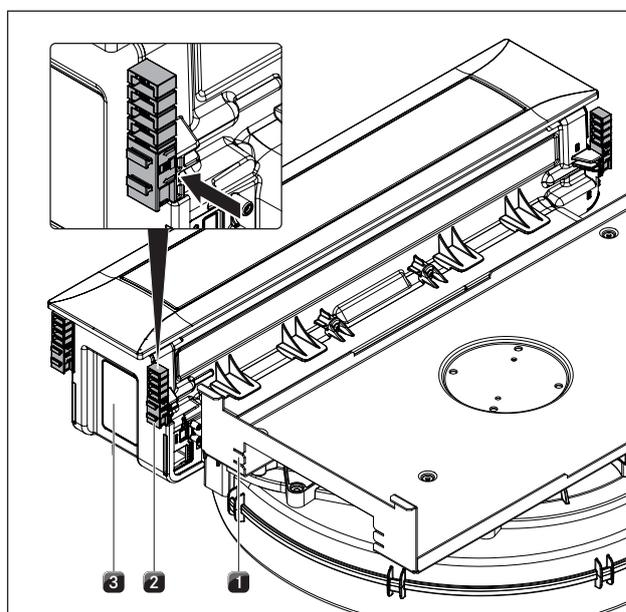
Fig. 6.13 Inserir grampos de montagem
