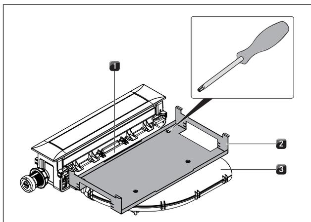
Fig. 6.24 Remover a chapa de retenção
