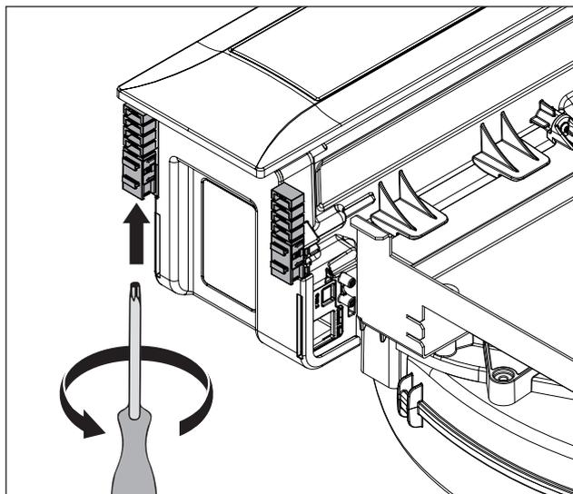
Fig. 6.14 Apertar os grampos de montagem
