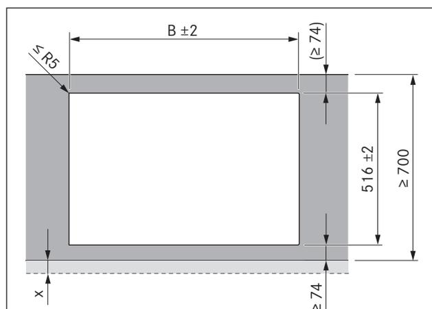
Fig. 6.5 Medidas de recorte, montagem por sobreposição
