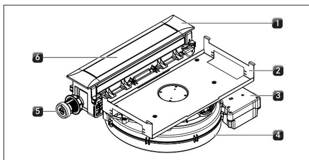
Fig. 5.2 Sistema de extração de superfície PKAS, PKASAB
