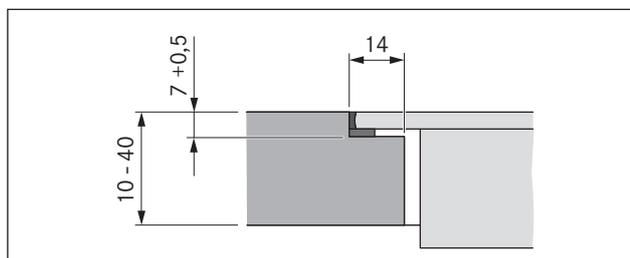
Fig. 6.4 Medida del pliegue para el montaje enrasado
