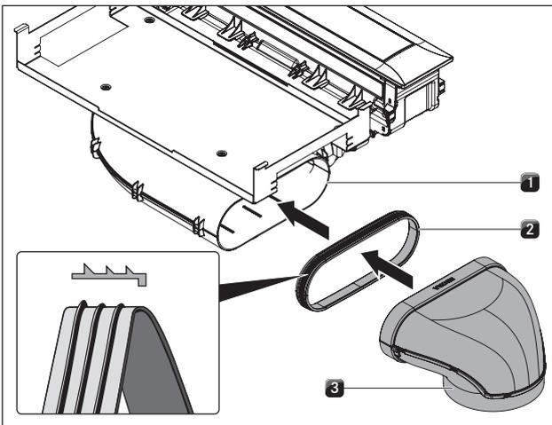
Fig. 6.33 Conexión al sistema de conductos
