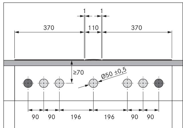
Fig. 6.20 Perforaciones en el panel para 2 placas de cocción, 2 cajas de enchufe y 1 extractor de superficie
