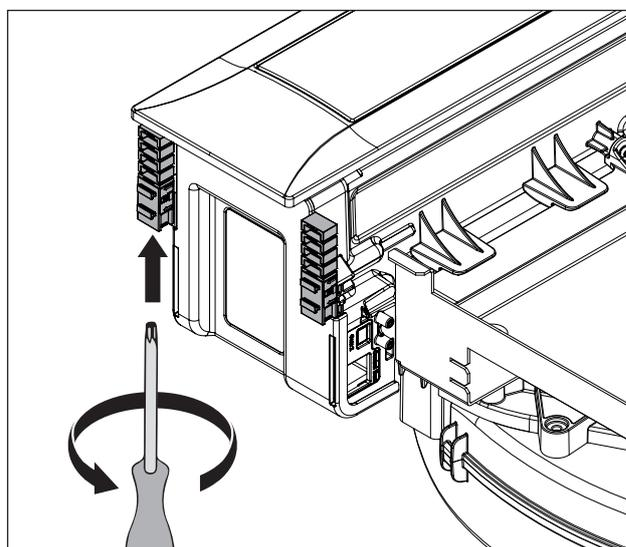
Fig. 6.14 Apretar las bornas de montaje
