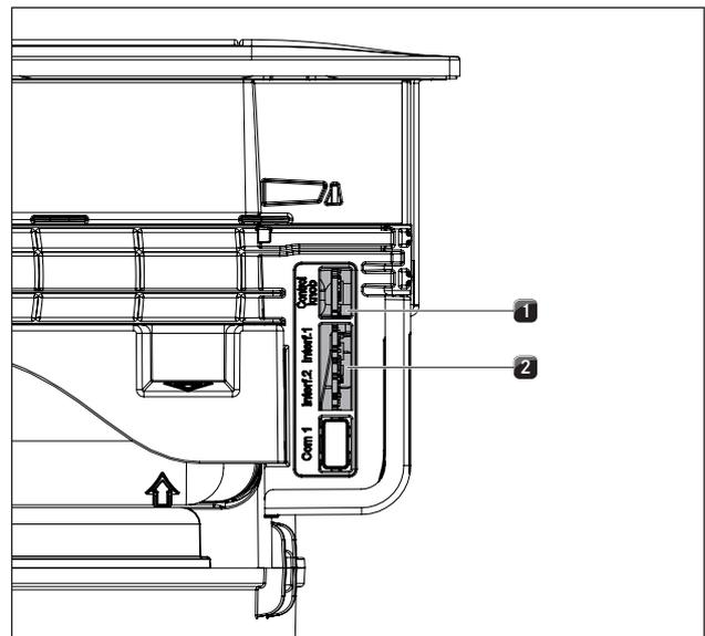
Fig. 6.44 Conexiones laterales del extractor de superficie
