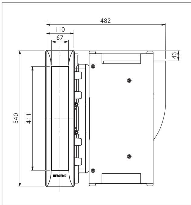
Fig. 3.1 PKA dimensiones del aparato vista en planta
