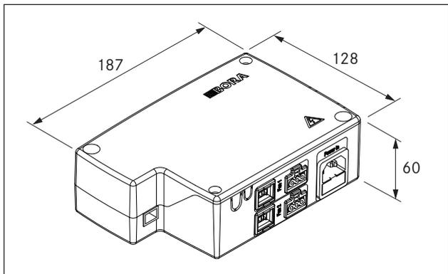
Fig. 3.4 Dimensiones del aparato unidad de control universal
