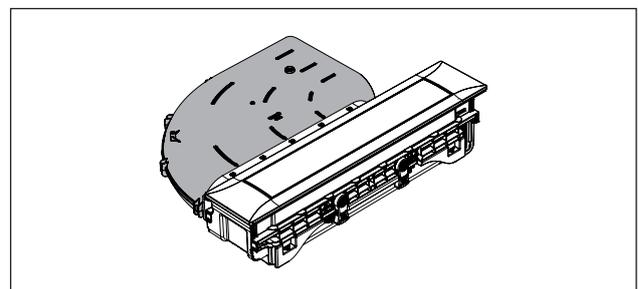
Fig. 6.28 Conducción de aire hacia la izquierda con la pieza de conducto acodada
