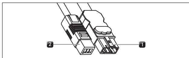
Fig. 6.48 Conector del ventilador de zócalo
