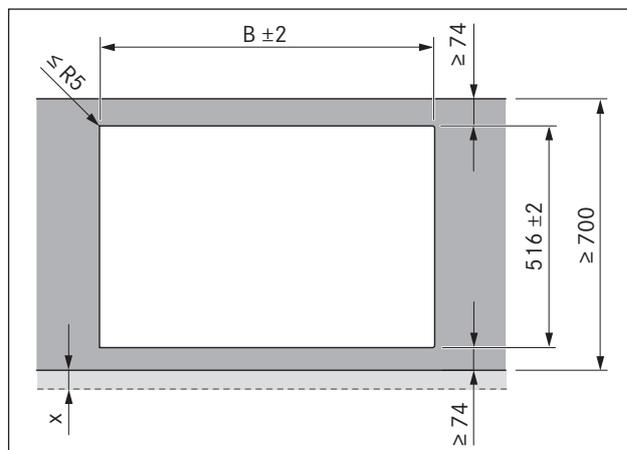
Fig. 6.5 Medidas del recorte para montaje superpuesto
