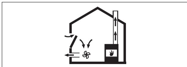
Fig. 6.36 Montaje con extracción - correcto
