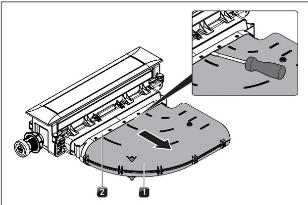
Fig. 6.25 Desmontar la pieza de conducto acodada
