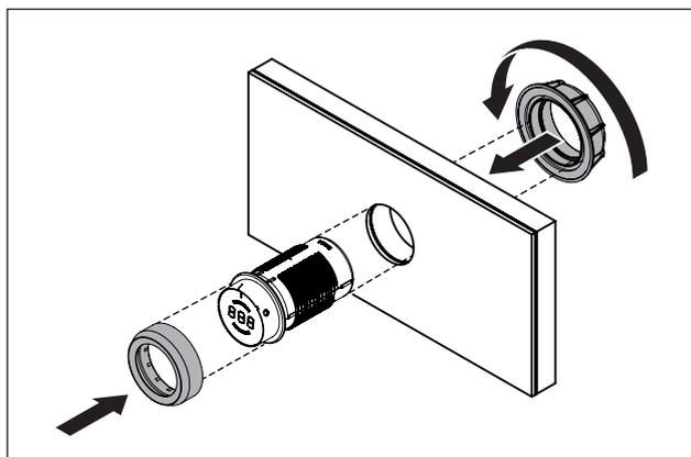
Fig. 6.23 Montar el mando selector
