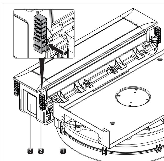
Fig. 6.13 Desplazar las bornas de montaje
