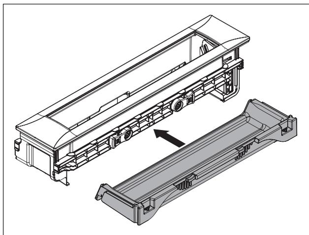
Fig. 8.6 Montaje de la bandeja de mantenimiento
