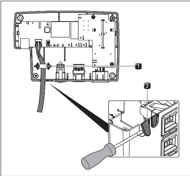
Fig. 6.42 Contacto Home Out con descarga de tracción
