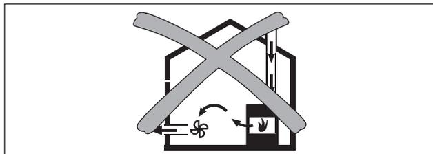
Fig. 6.35 Montaje con extracción - no admisible
