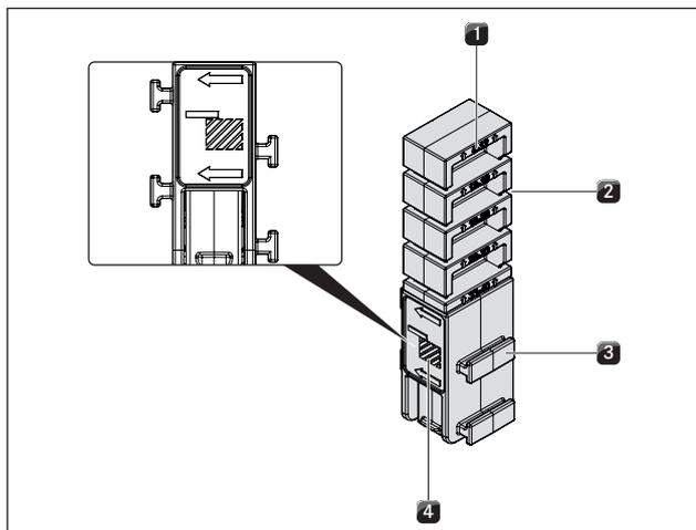
Fig. 6.12 Borna de montaje lado izquierdo (superposición)
