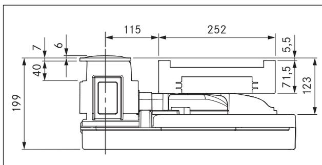
Fig. 3.6 PKAS, PKASAB dimensiones del aparato vista frontal
