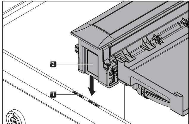
Fig. 6.9 Placas de compensación de altura
