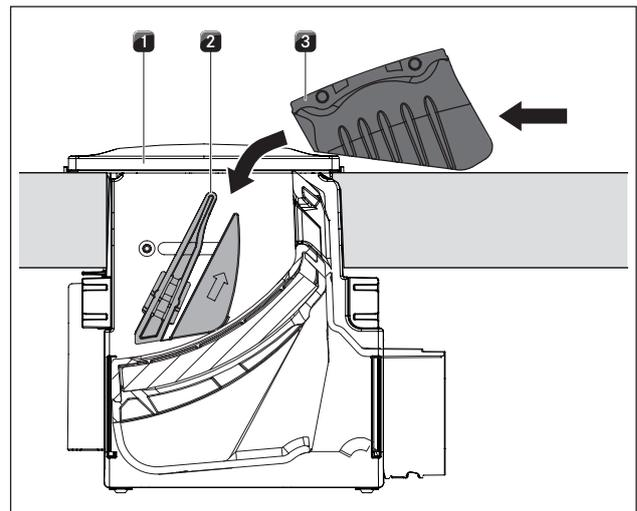
Fig. 8.4 Colocación de la tapa de cierre
