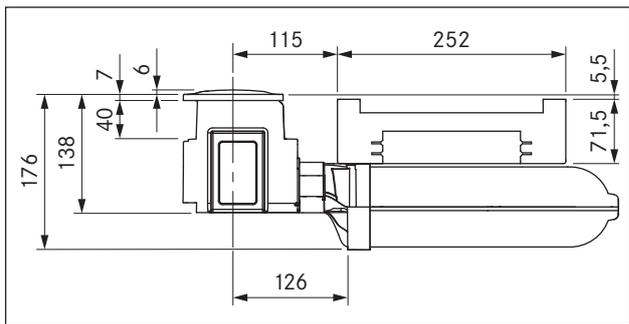
Fig. 3.2 PKA dimensiones del aparato vista frontal
