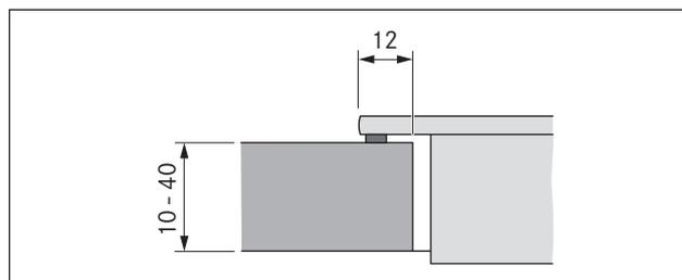
Fig. 6.6 Superposición del corte
