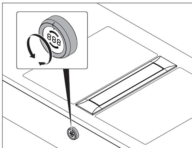
Fig. 7.2 Encendido del extractor de superficie
