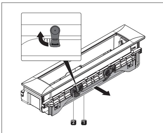
Fig. 8.5 Desmontaje de la bandeja de mantenimiento
