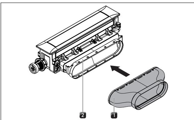
Fig. 6.26 Montar la pieza de conducto recta
