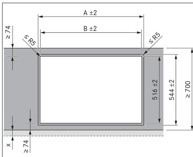
Fig. 6.3 Medidas del recorte para montaje enrasado
