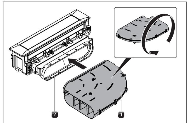
Fig. 6.27 Virar la pieza de conducto acodada
