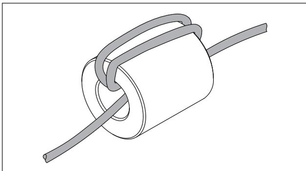
Fig. 6.39 Triple bobinado del cable de conexión sobre el núcleo de ferrita
