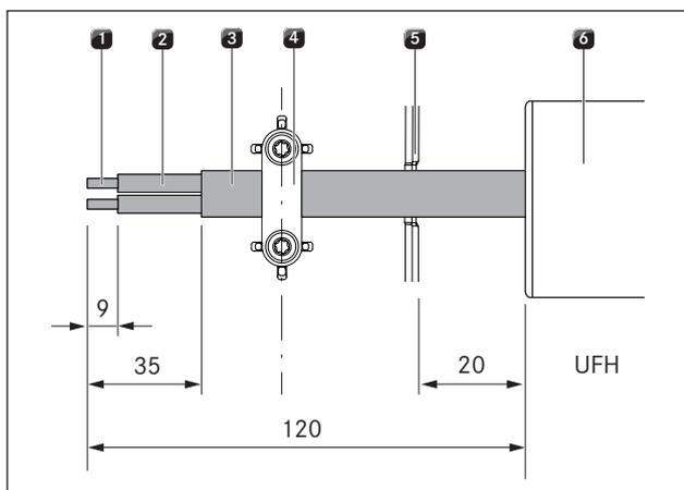
Fig. 6.40 Longitudes de desaislamiento y posición de montaje del cable de conexión
