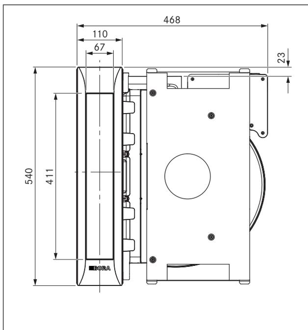
Fig. 3.5 PKAS, PKASAB dimensiones del aparato vista en planta
