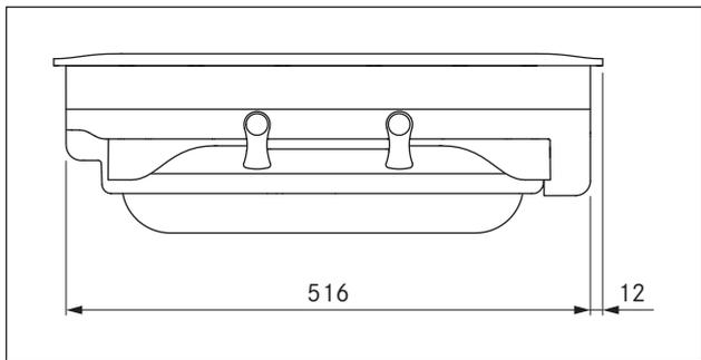
Fig. 3.3 PKA dimensiones del aparato vista lateral
