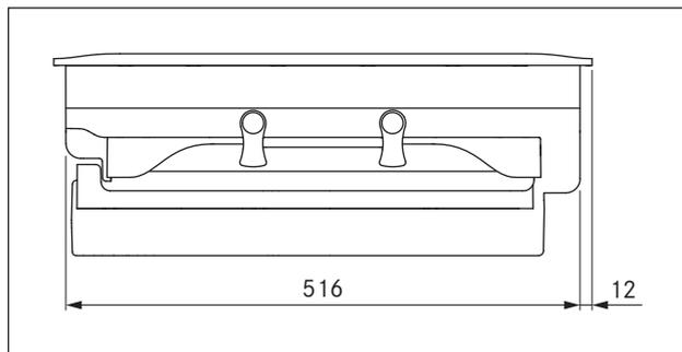
Fig. 3.7 PKAS, PKASAB dimensiones del aparato vista lateral
