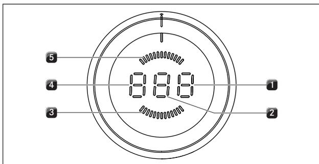
Fig. 5.6 Elementos de indicación mando selector
