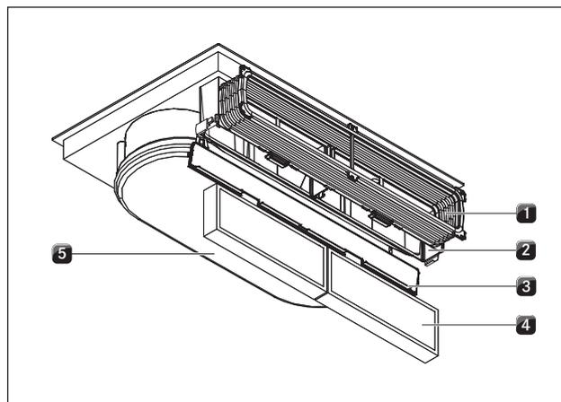
Fig. 5.2 Aspiratore per piano cottura a ricircolo (BHU)
