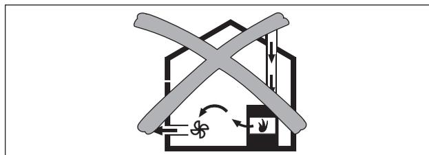
Fig. 6.19 Montaggio con scarico aria non consentito
