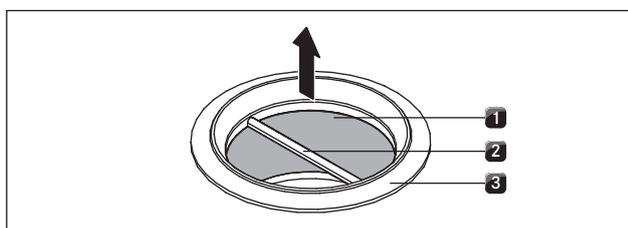
Fig. 8.2 Smontaggio del filtro antigrasso in acciaio inox
