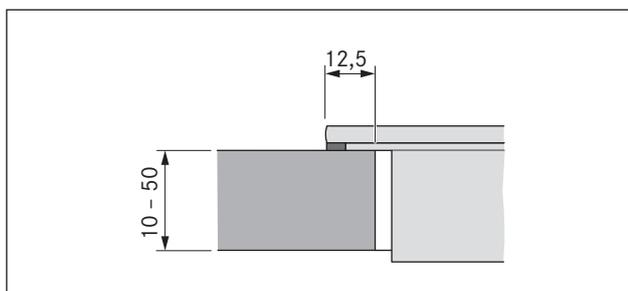
Fig. 6.6 Dimensioni di appoggio per montaggio soprapiano
