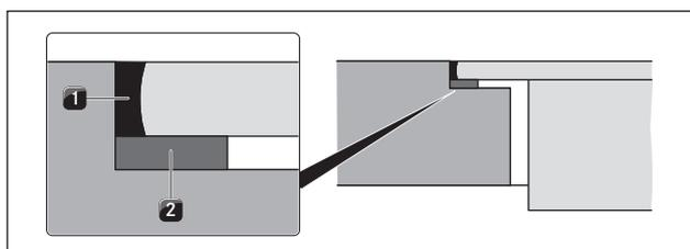
Fig. 6.8 Nastro a tenuta per montaggio a filo
