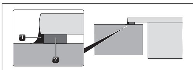
Fig. 6.7 Nastro a tenuta montaggio soprapiano
