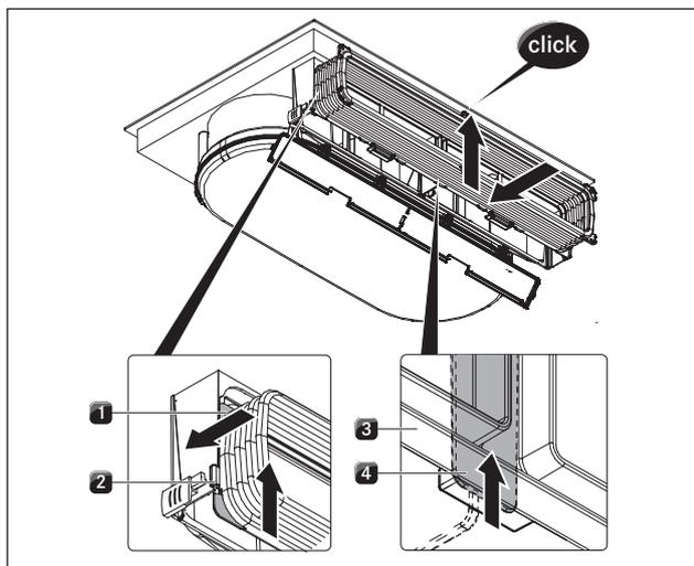
Fig. 6.15 Sospendere il telaio della canalina flessibile
