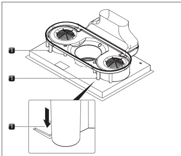
Fig. 6.25 Sbloccaggio del fissaggio di posizionamento
