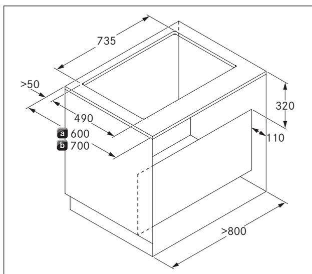
Fig. 6.21 Dimensioni mobile con aria di scarico
