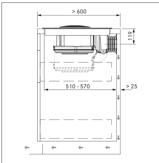
Fig. 6.10 Dimensioni di montaggio con ricircolo aria, profondità piano di lavoro 600 mm
