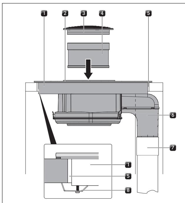
Fig. 6.35 Chiudere il canale di scarico dell'aria + fissaggio
