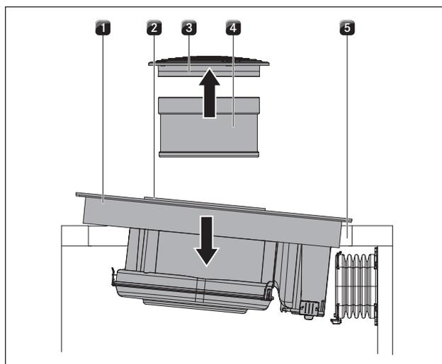
Fig. 6.13 Inserire il piano di cottura obliquamente
