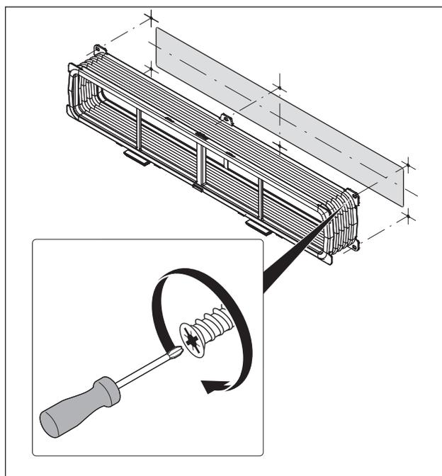
Fig. 6.12 Canalina flessibile con 6 viti EURO 6,3x10 mm
