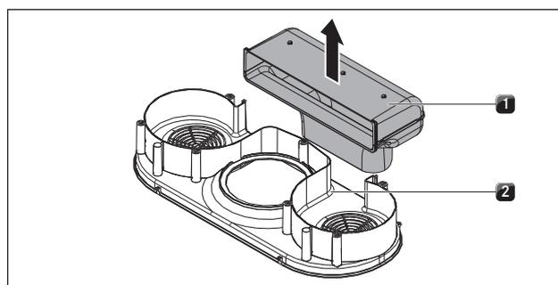
Fig. 6.28 Rimuovere l'arco di scarico
