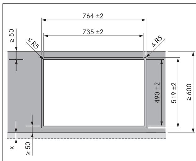
Fig. 6.3 Dimensioni del taglio per montaggio a filo
