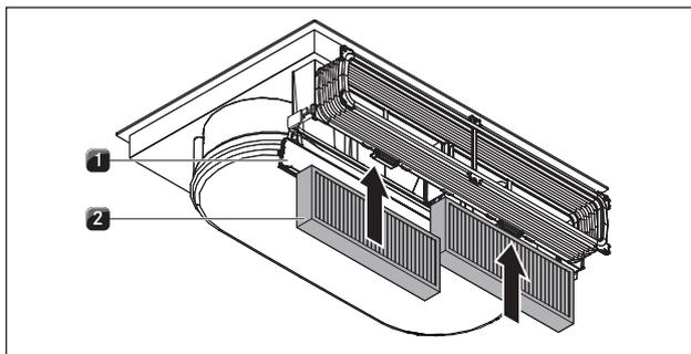
Fig. 6.16 Inserire il filtro al carbone attivo
