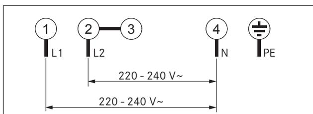
Fig. 6.37 Schema di connessione collegamento bifase
