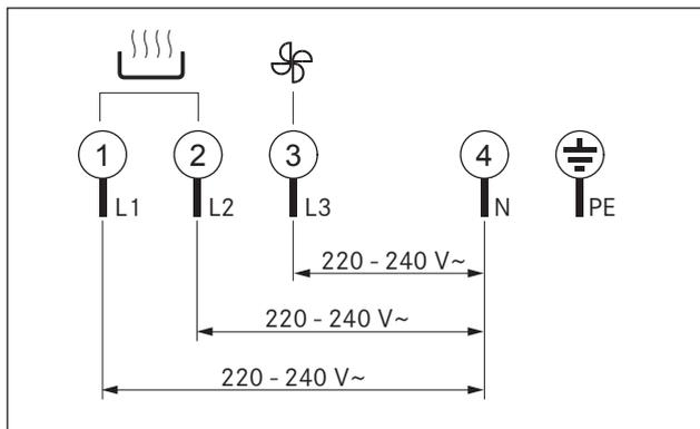
Fig. 6.36 Schema di connessione collegamento trifase
