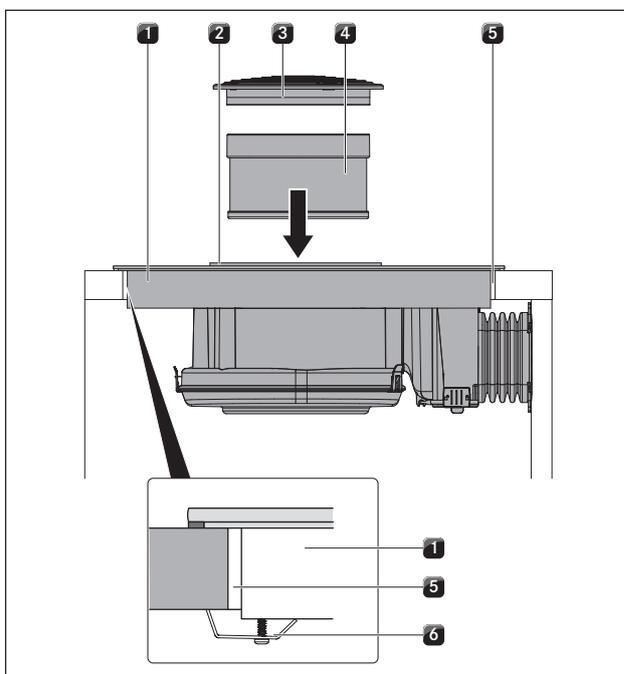
Fig. 6.17 Fissare centralmente il piano di cottura
