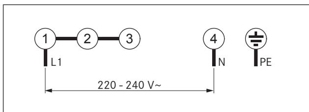
Fig. 6.38 Schema di connessione collegamento monofase
