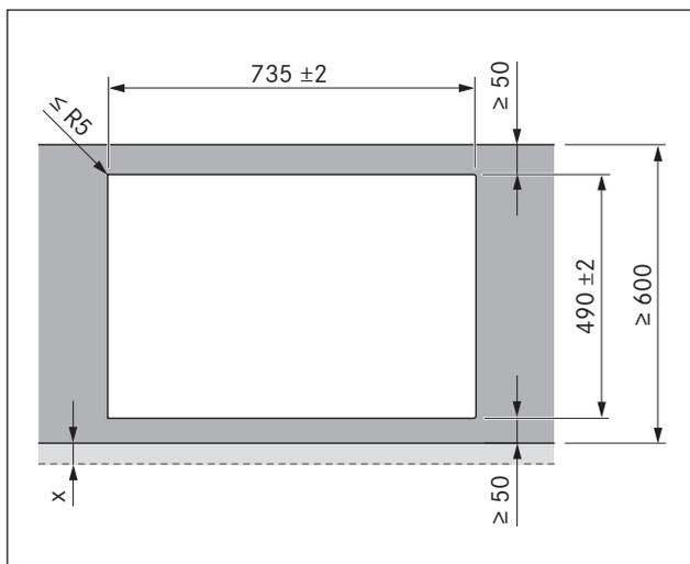
Fig. 6.5 Dimensioni di taglio per montaggio soprapiano
