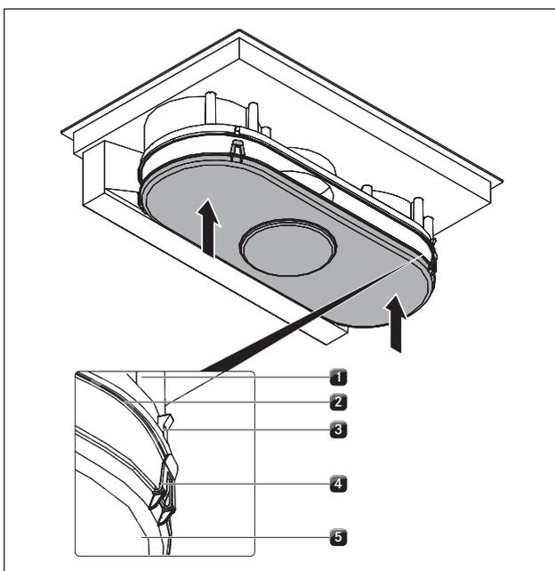
Abb. 8.4 Luftführungsgehäuse schließen
