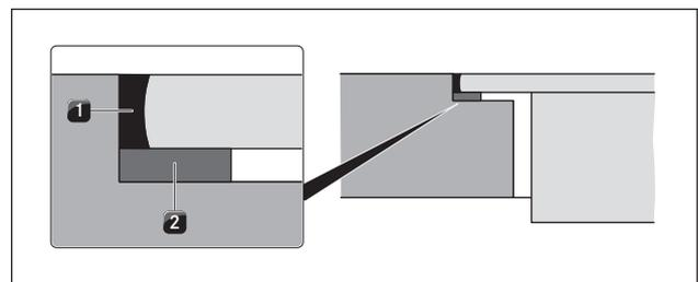
Abb. 6.7 Dichtungsband bei flächenbündiger Montage
