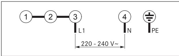
Abb. 6.38 Anschlusschema 1-Phasen-Anschluss
