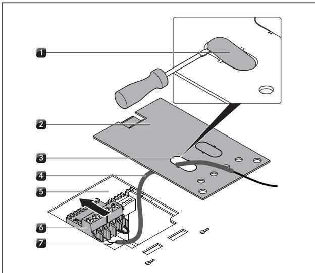
Abb. 6.43 Leitung anschließen
