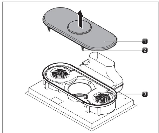
Abb. 6.25 Gehäuseboden abnehmen
