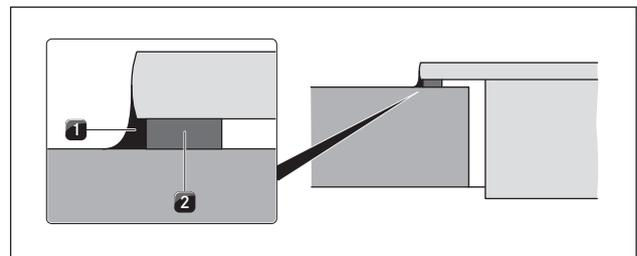
Abb. 6.6 Dichtungsband bei Aufsatzmontage
