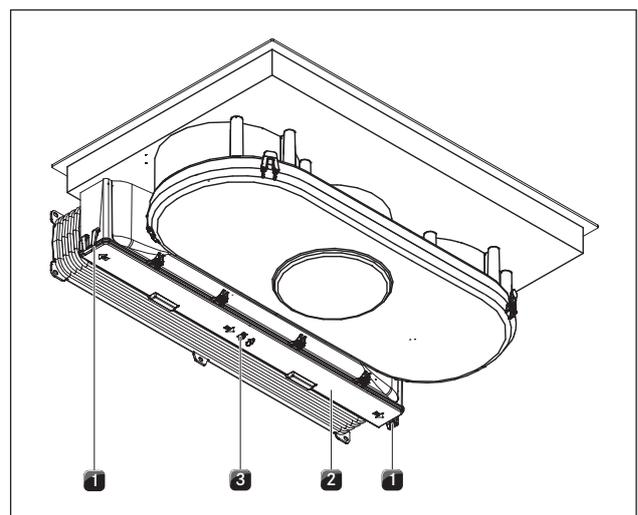
Abb. 8.5 Aktivkohlefiltergehäusedeckel entriegeln
