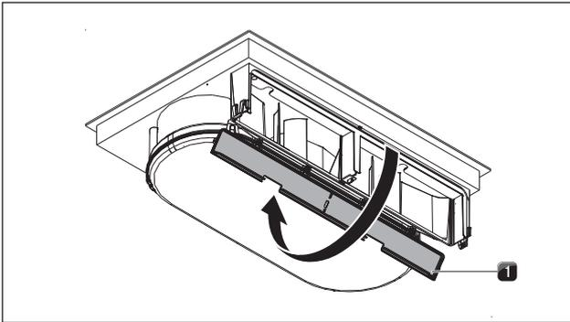
Abb. 6.15 Gehäusedeckel öffnen
