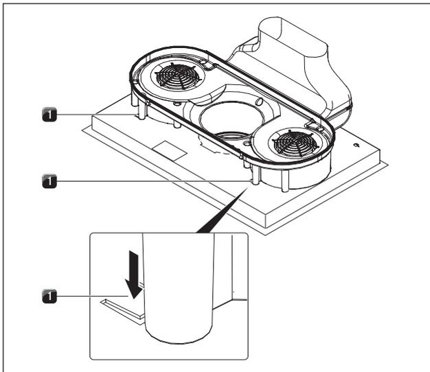
Abb. 6.26 Lagesicherung entriegeln
