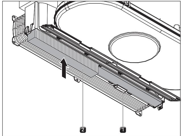
Abb. 8.9 Aktivkohlefilter einsetzen
