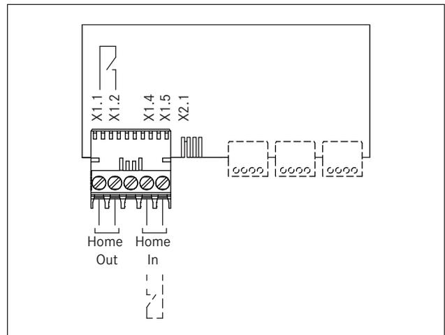
Abb. 6.42 Anschlussschema externe Schaltkontakte
