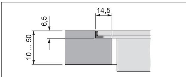
Abb. 6.3 Falzmaß für flächenbündige Montage
