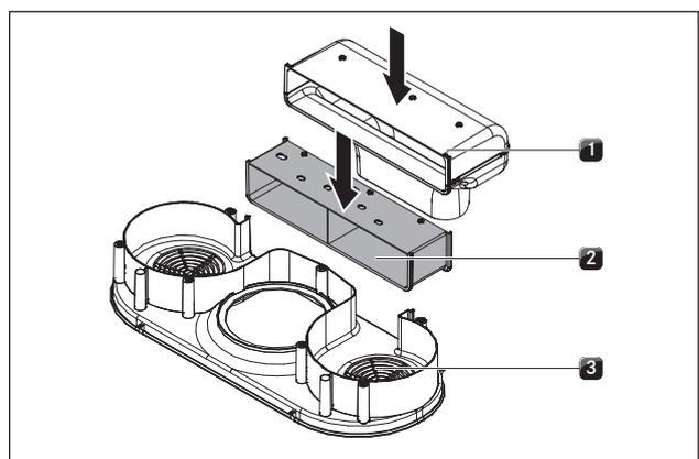
Abb. 6.30 Abluftkanalverlängerung einsetzen
