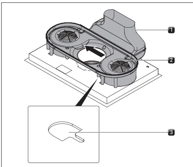
Abb. 6.27 Luftführungsgehäuse verschieben
