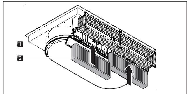
Abb. 6.17 Aktivkohlefilter einsetzen
