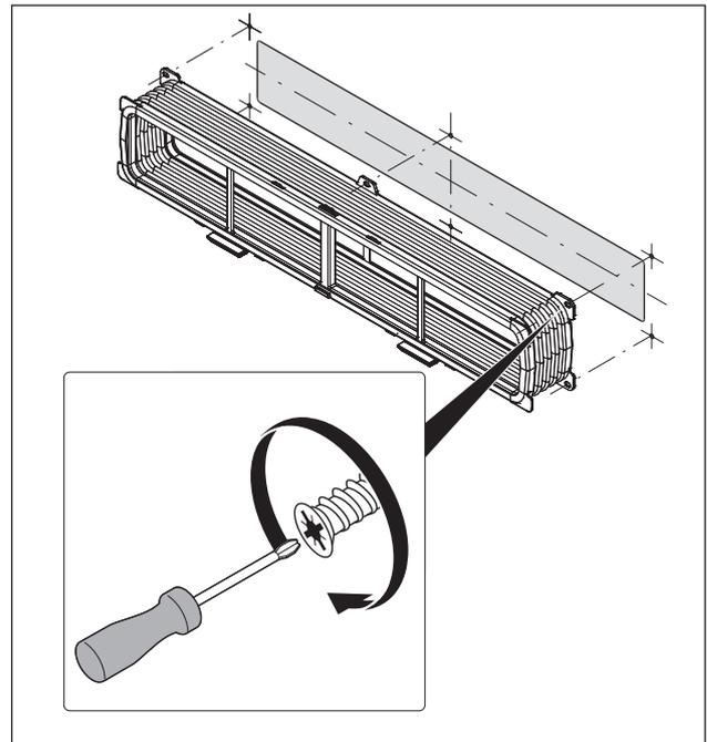
Abb. 6.13 Flexkanal mit 6 EURO-Schrauben 6,3 x 10 mm
