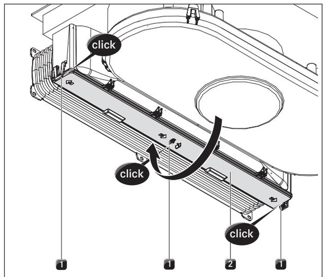
Abb. 8.10 Aktivkohlefiltergehäusedeckel schließen
