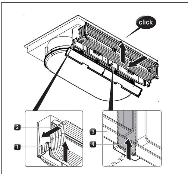
Abb. 6.16 Rahmen des Flexkanals einhängen
