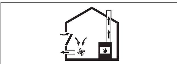
Abb. 6.20 Abluftmontage – korrekt
