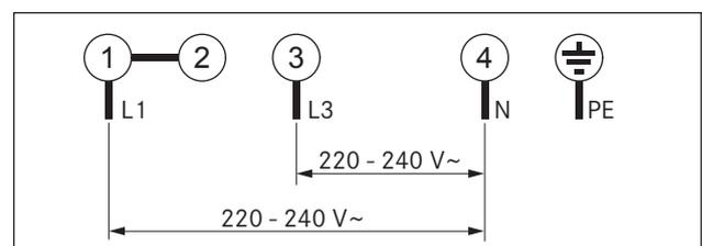
Abb. 6.37 Anschlussschema 2-Phasen-Anschluss
