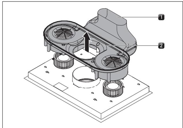
Abb. 6.28 Luftführungsgehäuse abnehmen
