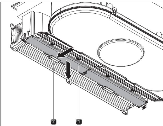
Abb. 8.8 Aktivkohlefilter entnehmen
