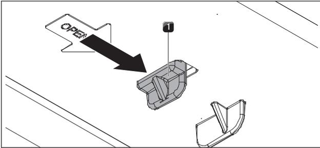
Abb. 8.6 Mittlere Verriegelung öffnen
