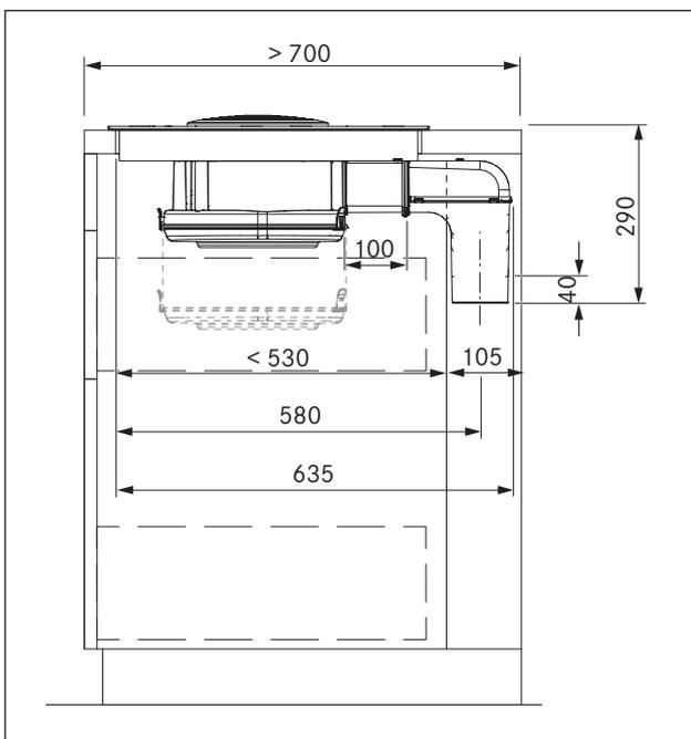
Abb. 6.24 Einbaumaße bei Abluft, Arbeitsplattentiefe ab 700 mm
