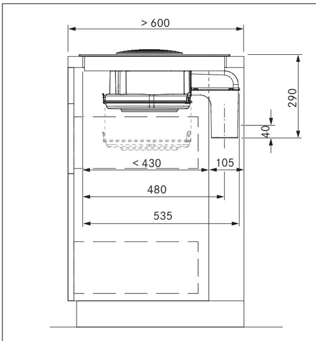
Abb. 6.23 Einbaumaße bei Abluft, Arbeitsplattentiefe 600 mm
