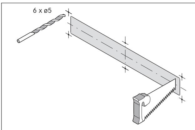
Abb. 6.12 Ausschnitt und Anschlussbohrungen
