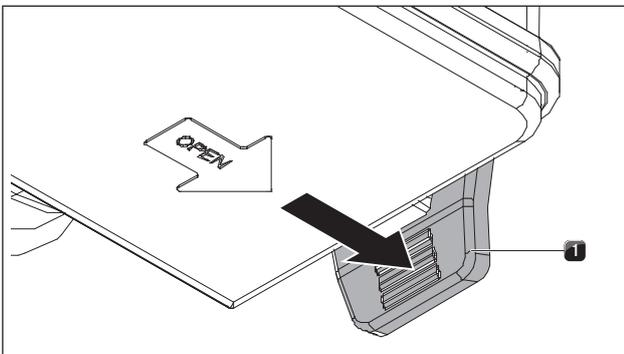
Abb. 8.7 Äußere Verriegelungen öffnen
