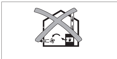
Fig. 9.1 Montage à évacuation de l'air - non autorisé
