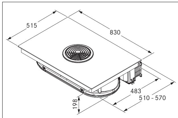
Abb. 6.9 Размеры устройства при циркуляции воздуха
