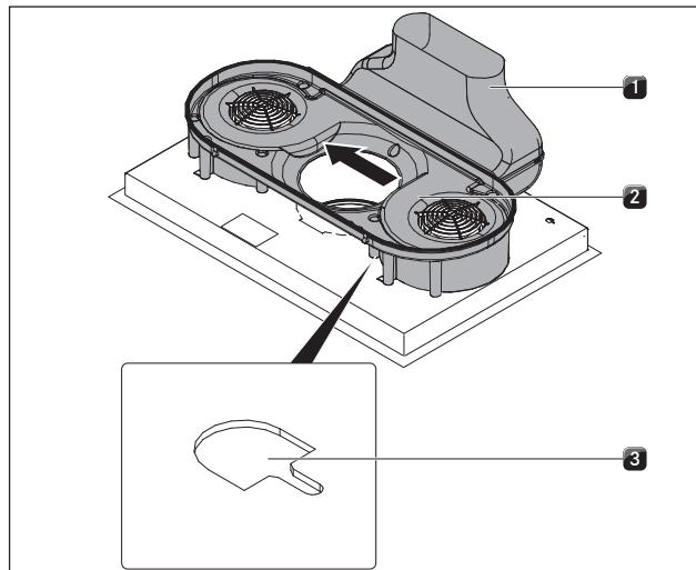
Abb. 6.27 Перемещение корпуса воздуховода
