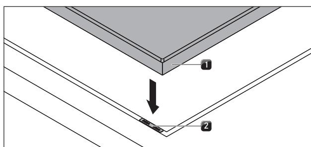
Abb. 6.8 Пластины для компенсации высоты
