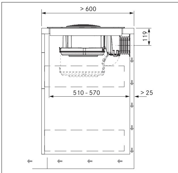
Abb. 6.11 Монтажные размеры при циркуляции воздуха, глубина столешницы 600 мм
