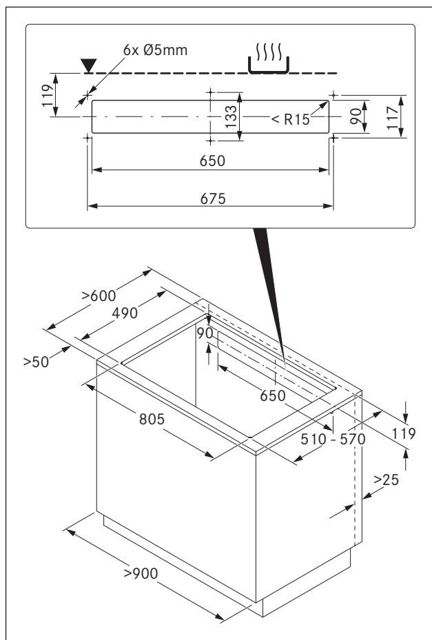
Abb. 6.10 Размеры мебели при циркуляции воздуха
