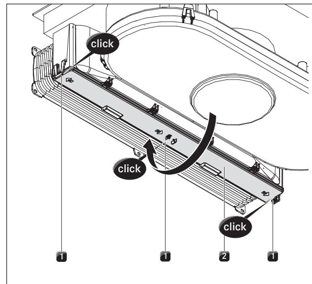
Abb. 8.10 Закройте крышку корпуса фильтра с активированным углем
