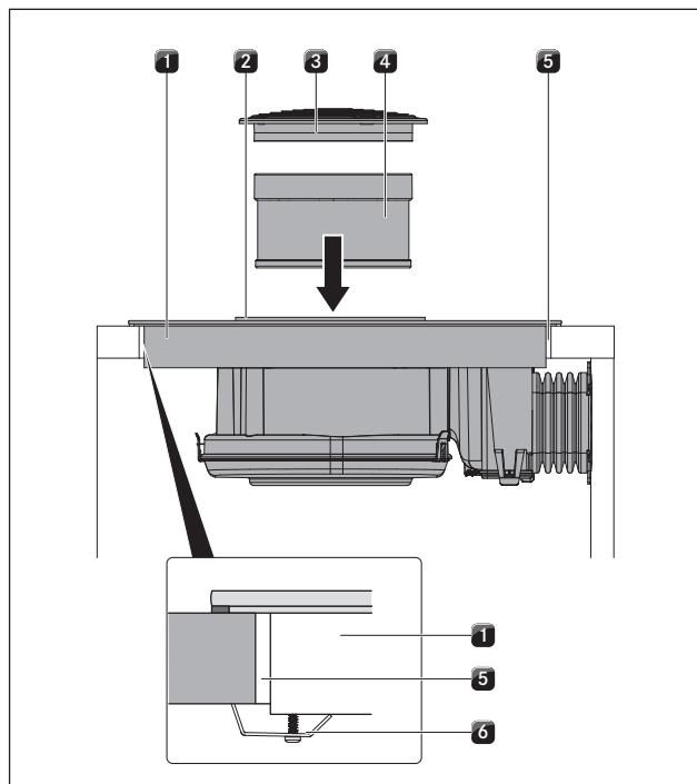
Abb. 6.18 Крепление варочной панели по центру
