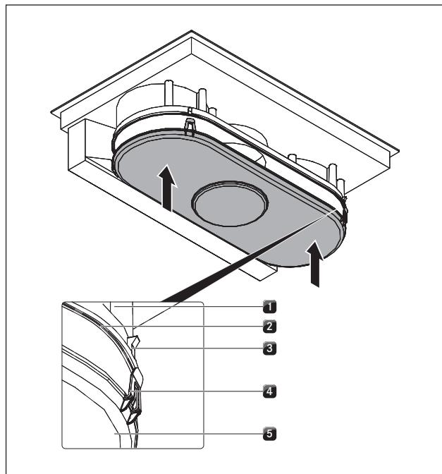
Abb. 8.4 Закрытие корпуса воздуховода
