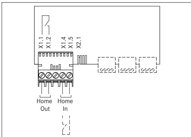
Abb. 6.42 Схема подключения внешних переключающих контактов
