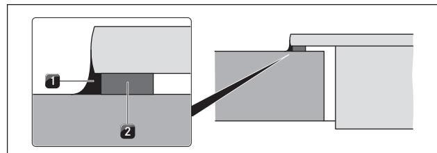
Abb. 6.6 Уплотнительная лента для навесного монтажа
