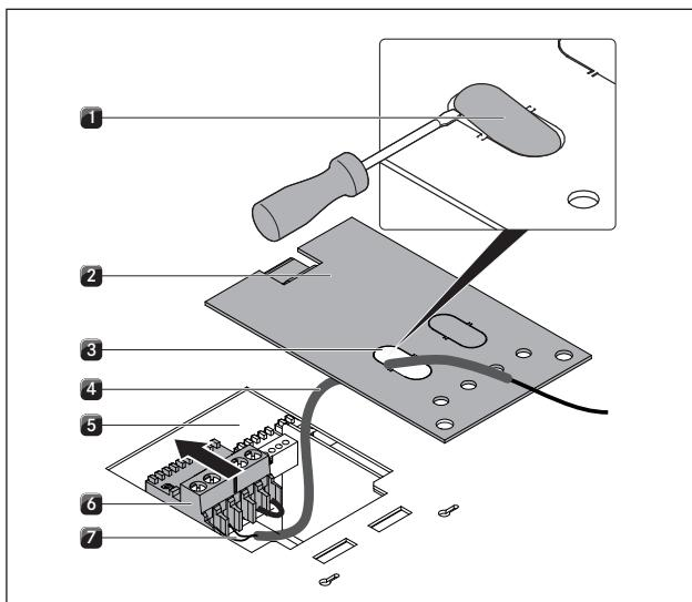
Abb. 6.43 Подсоединение проводов
