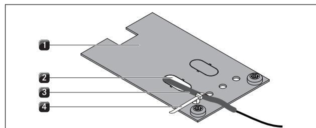
Abb. 6.44 Установка зажима для разгрузки провода от натяжения
