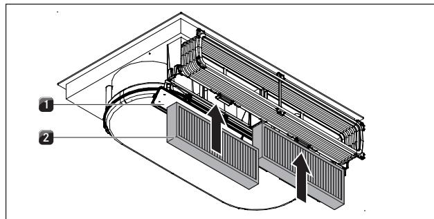
Abb. 6.17 Установка угольного фильтра
