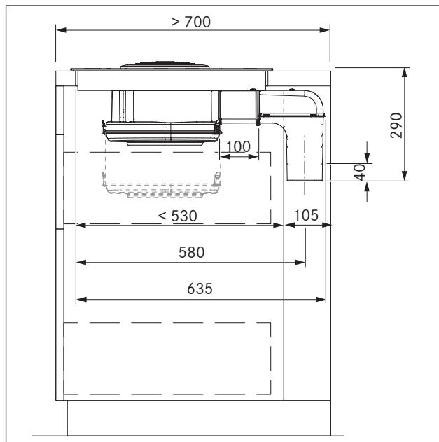
Abb. 6.24 Монтажные размеры при вытяжном воздухе, глубина столешницы 700 мм
