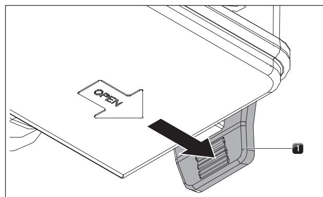
Abb. 8.7 открытие наружных фиксаторов
