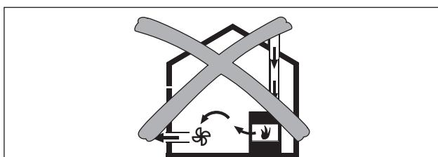
Abb. 6.19 Монтаж отвода воздуха – недопустимо
