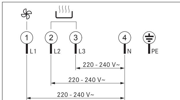
Abb. 6.36 Схема трёхфазного подключения
