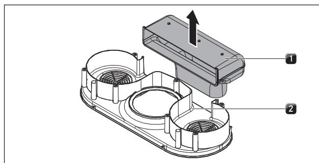
Abb. 6.29 Снятие колена отвода воздуха
