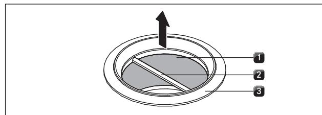
Abb. 8.2 Демонтаж жирового фильтра из нержавеющей стали
