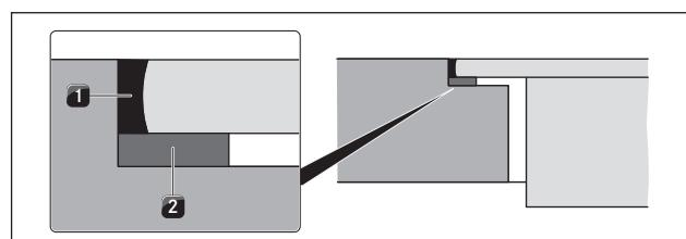
Abb. 6.7 Уплотнительная лента при монтаже заподлицо
