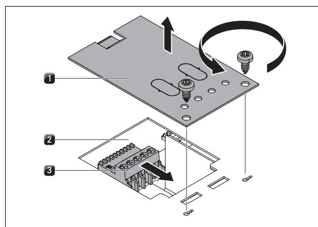
Abb. 6.41 Откройте крышку и удалите контактный штекер
