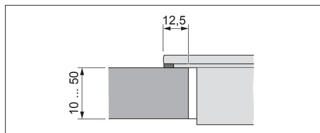
Abb. 6.5 Размер опорной поверхности для навесного монтажа
