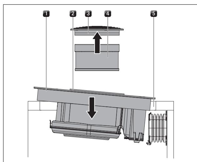
Abb. 6.14 Вставка варочной панели по диагонали
