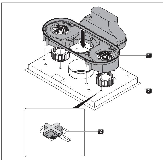
Abb. 6.31 Установка блока воздуховодов на дне варочной панели
