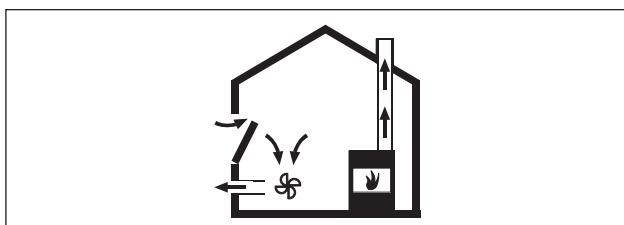
Abb. 6.20 Монтаж отвода воздуха – правильно
