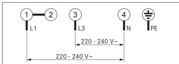
Abb. 6.37 Схема двухфазного подключения
