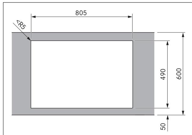
Abb. 6.4 Размеры выреза для навесного монтажа
