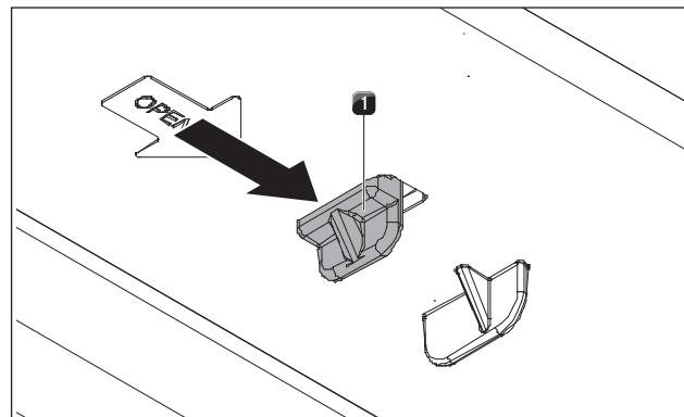
Abb. 8.6 откройте фиксаторы, расположенные в центре
