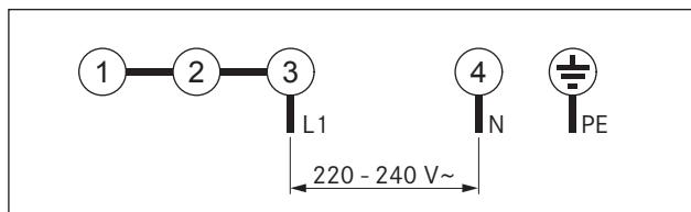
Abb. 6.38 Схема однофазного подключения
