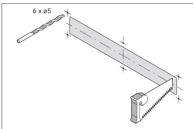
Abb. 6.12 Вырез и присоединительные отверстия
