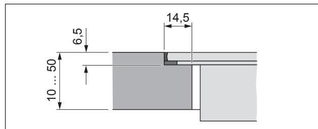
Abb. 6.3 Размер паза для монтажа заподлицо
