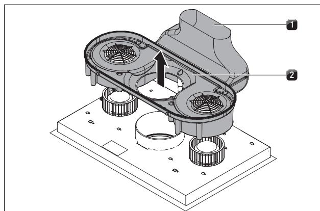
Abb. 6.28 Снятие корпуса воздуховода
