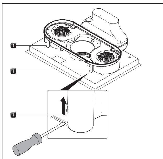
Abb. 6.33 Стопорное устройство
