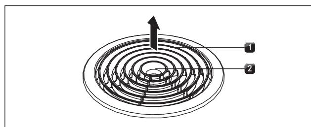
Abb. 8.1 Демонтаж входного сопла
