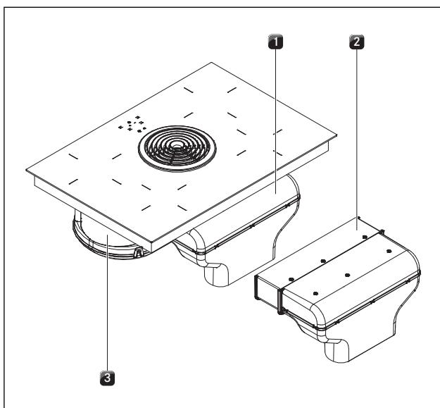
Abb. 5.3 Вытяжной воздух вытяжки, встраиваемой в столешницу (BFIA)
