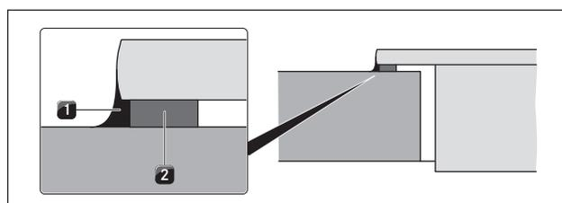
Fig. 5.8 Ruban d'étanchéité pour montage par le dessus
