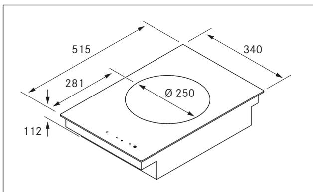
Fig. 3.1 Dimension de l'appareil
