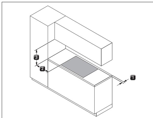
Fig. 5.1 Distances minimales recommandées
