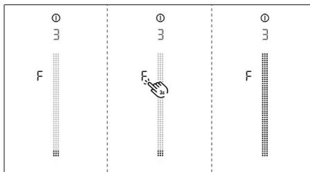
Abb. 8.4 Menüpunkt 3: Filterstand und Filterserviceanzeige zurücksetzen
