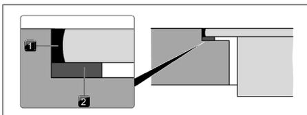
Abb. 11.18 Dichtungsband bei flächenbündiger Montage
