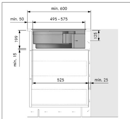
Abb. 11.16 Einbaumaße bei Umluft-Montagevariante B, Arbeitsplattentiefe 600 mm
