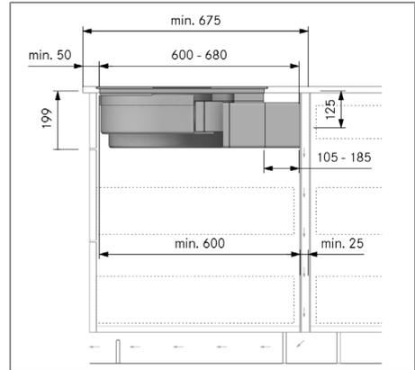
Abb. 11.14 Einbaumaße bei Umluft-Montagevariante A, Arbeitsplattentiefe ab 675 mm
