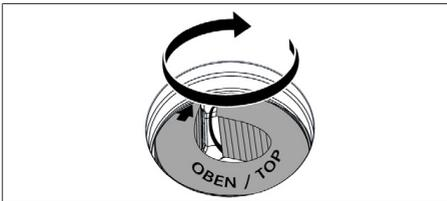
Abb. 9.9 Aktivkohlefilter in Endposition platzieren
