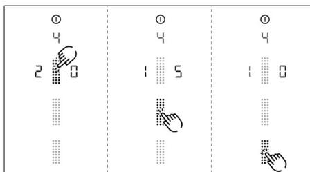
Abb. 8.5 Menüpunkt 4: Dauer der Nachlaufautomatik auswählen
