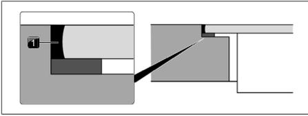
Abb. 11.36 Silikondichtmasse bei flächenbündiger Montage
