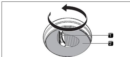
Abb. 9.5 Aktivkohlefilter aus dem Filtergehäuse drehen
