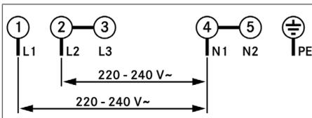
Abb. 11.29 Anschlusschema 2-Phasen-Anschluss
