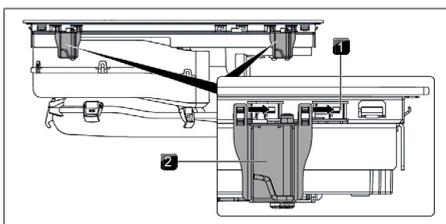
Abb. 11.19 Montageklammern anbringen
