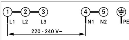
Abb. 11.28 Anschlusschema 1-Phasen-Anschluss
