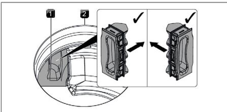
Abb. 9.10 Filterwechselklappe einsetzen
