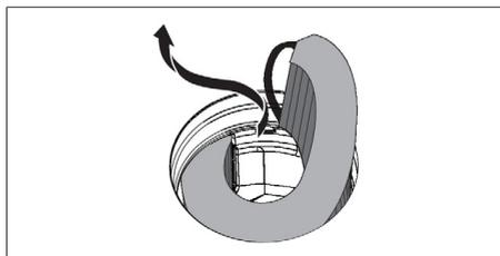
Abb. 9.6 Aktivkohlefilter aus der Einströmöffnung entnehmen
