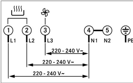
Abb. 11.27 Anschlusschema 3-Phasen-Anschluss
