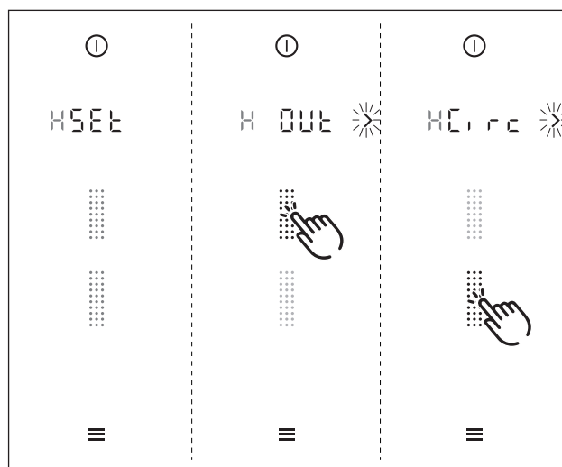
Obr. 5.1 Konfigurácia indikácie systému odvodu vzduchu
