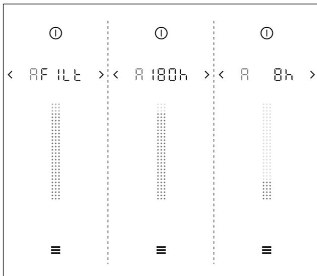
Fig. 6.12 Option de menu A : Affichage de la durée de vie du filtre de recyclage
