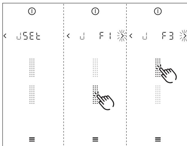
Fig. 7.7 Sélection du type de filtre
