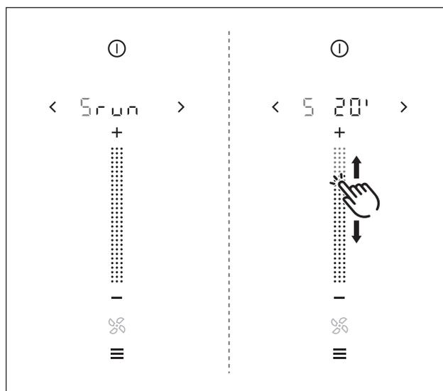
Fig. 6.6 Option de menu 4 : Durée du verrouillage au nettoyage
