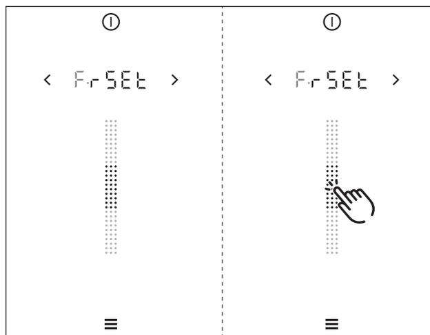
Fig. 7.5 Option de menu D : Réinitialisation sur les réglages d'usine
