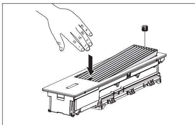
Fig. 8.1 Retrait de la buse d'aspiration
