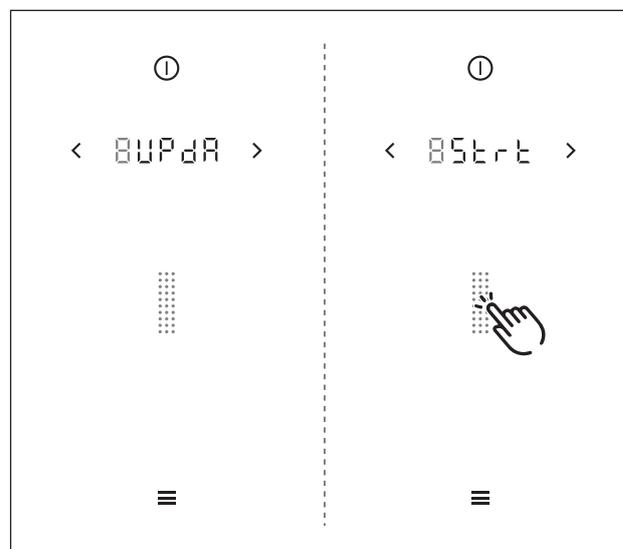
Fig. 6.9 Option de menu 8 : Démarrage de la mise à jour du logiciel
