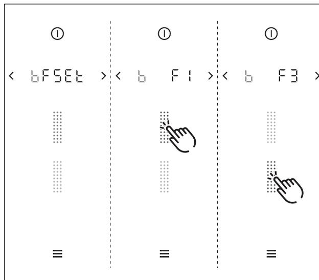
Fig. 6.13 Option de menu B : Affichage du type de filtre, remplacement du filtre et réinitialisation de la durée de vie du filtre
