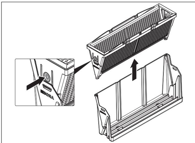
Fig. 8.3 Retrait du filtre à graisses
