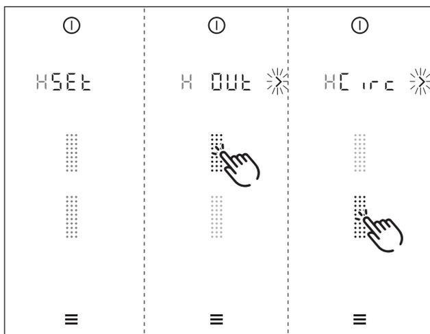
Fig. 7.6 Réglage du mode de circulation de l'air
