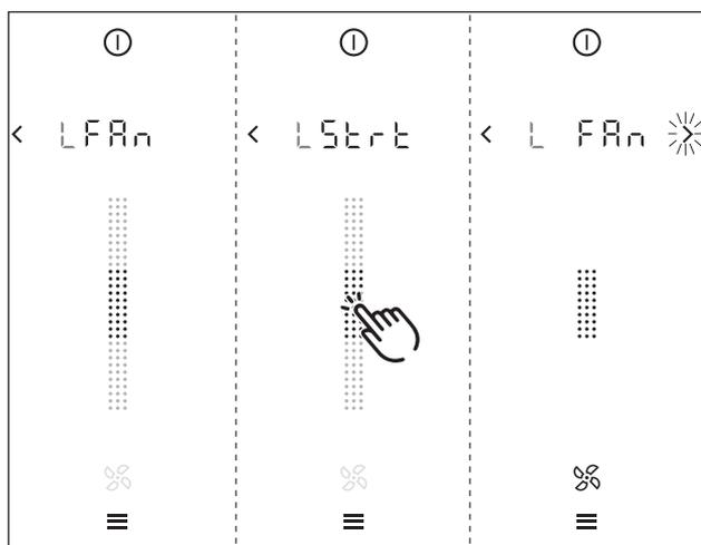
Fig. 7.8 Démarrage de la configuration des ventilateurs
