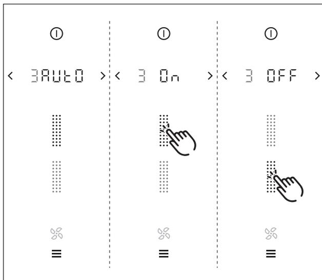
Fig. 6.4 Option de menu 3 : Système d'aspiration automatique
