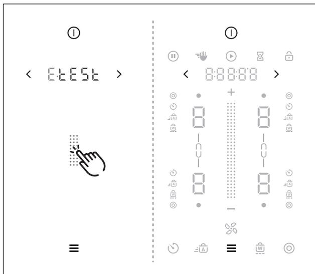
Fig. 7.4 Option de menu E : Test de l'affichage et du clavier
