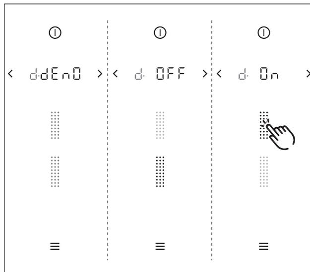
Fig. 7.3 Option de menu D : Activation du mode de démonstration
