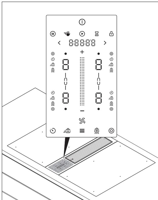
Fig. 4.1 Zone de commande centrale tactile
