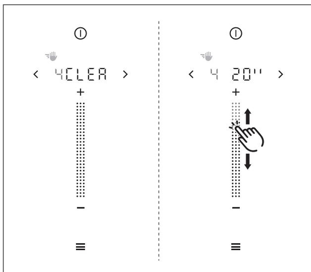
Fig. 6.5 Option de menu 4 : Durée du verrouillage au nettoyage
