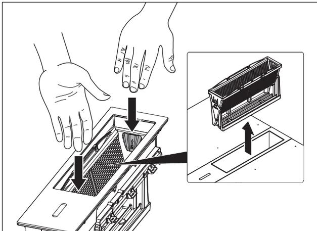
Fig. 8.2 Retrait de l'unité du filtre à graisses
