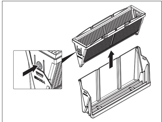
Fig. 9.3 Desmontaje del filtro de grasa
