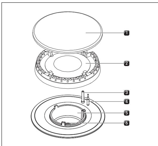
Fig. 9.5 Estructura del quemador de gas
