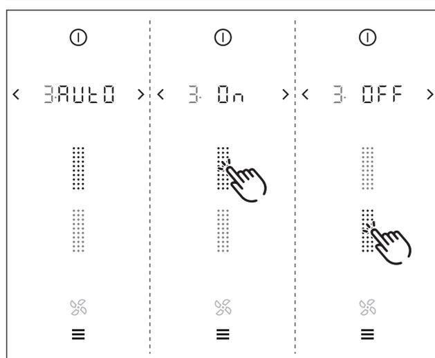
Fig. 7.4 Opción de menú 3: Mecanismo automático de extracción
