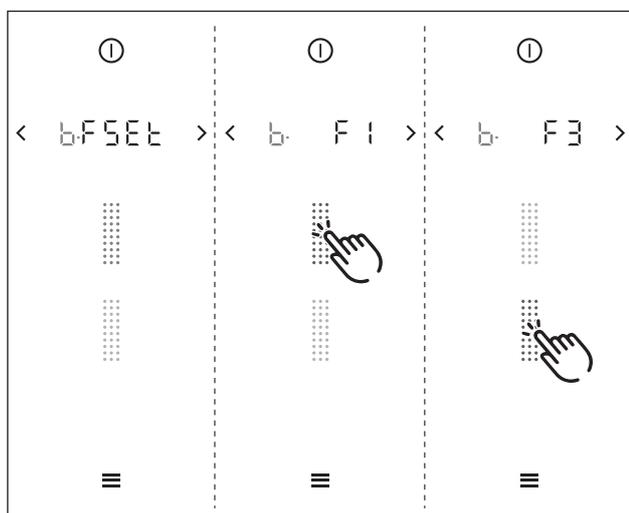
Fig. 8.2 Opción de menú B: Mostrar tipo de filtro, cambiar tipo de filtro y reiniciar vida útil del filtro
