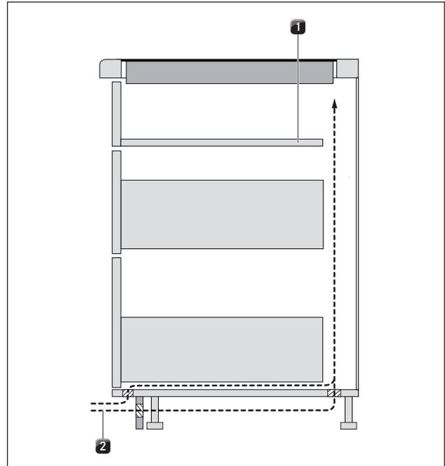
Fig. 4.7 Alimentation en air dans le socle
