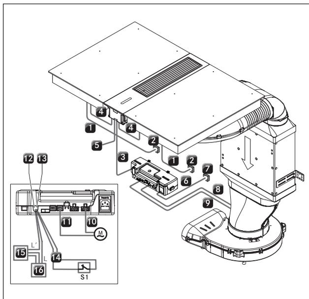
Fig. 4.38 Schéma de raccordement du dispositif aspirant CKA2/CKA2AB
