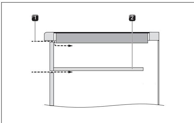
Fig. 4.6 Alimentation en air à l'avant
