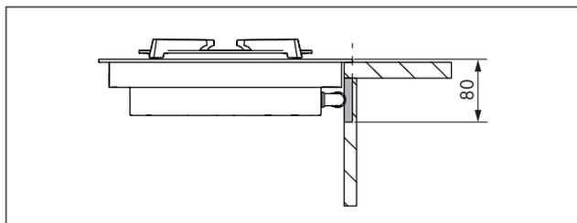
Fig. 4.9 Découpe latérale pour le raccordement du gaz (vue avant)
