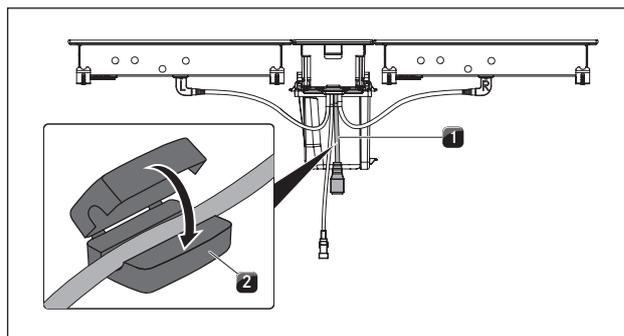
Fig. 4.40 Pose du noyau de ferrite
