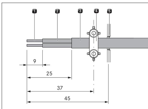
Fig. 4.34 Longueurs de dénudage et position de montage du câble de raccordement
