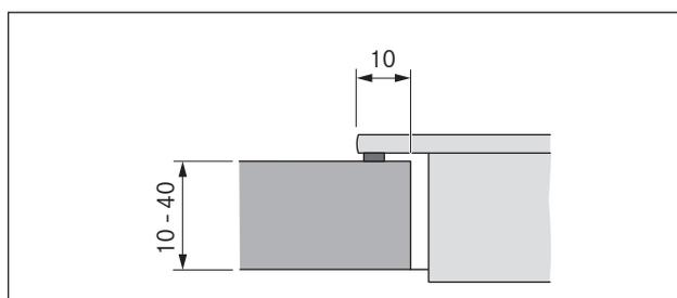
Fig. 4.13 Cote d'appui pour montage en saillie
