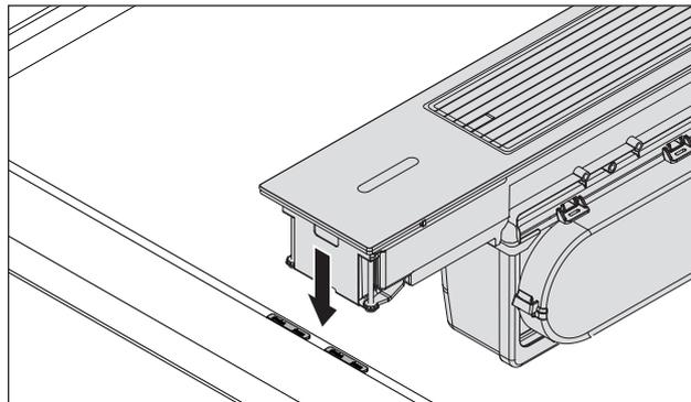
Fig. 4.24 Plaques de compensation en montage affleurant
