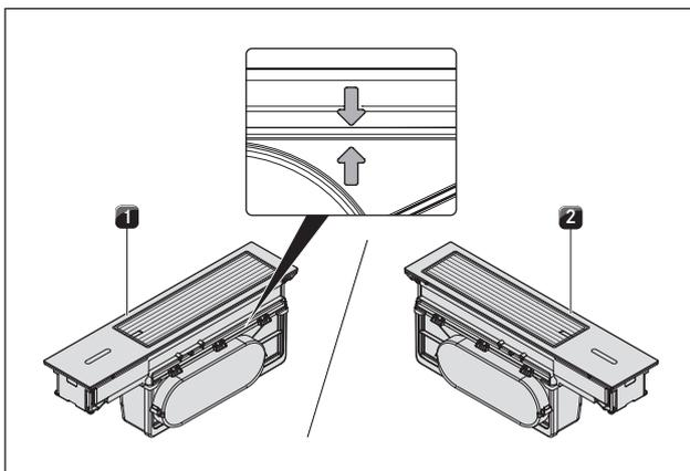
Fig. 4.21 Dispositif aspirant CKA2/CKA2AB assemblé
