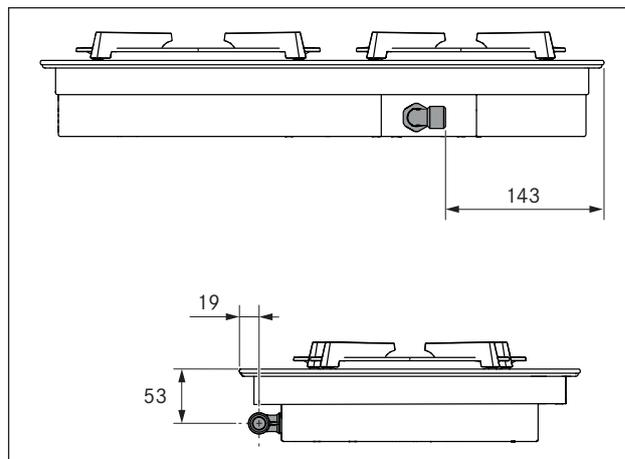
Fig. 4.45 Position du raccord de gaz
