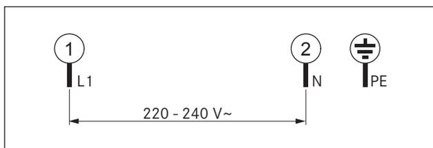
Fig. 4.44 Schéma de raccordement monophasé de la table de cuisson
