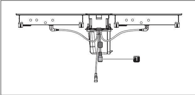
Fig. 4.41 Connecteur pour câble de communication CAT 5e sur l'unité de commande
