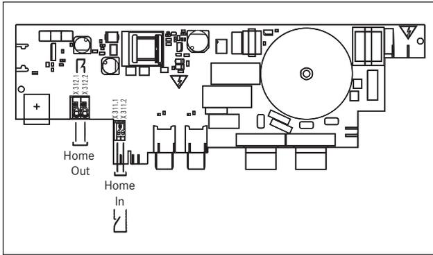
**Fig. 4.35** Schéma de raccordement pour commutateurs externes
