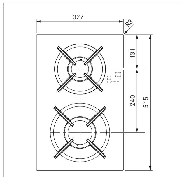
Fig. 3.20 Dimensions CKG - Vue de dessus
