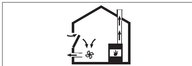
Fig. 4.2 Montage à évacuation de l'air - correct
