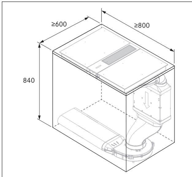
Fig. 4.14 Dimensions minimales de montage avec silencieux plat USDF
