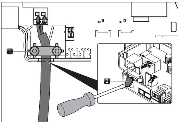
**Fig. 4.36** Connexion sur Home Out avec serre-câble
