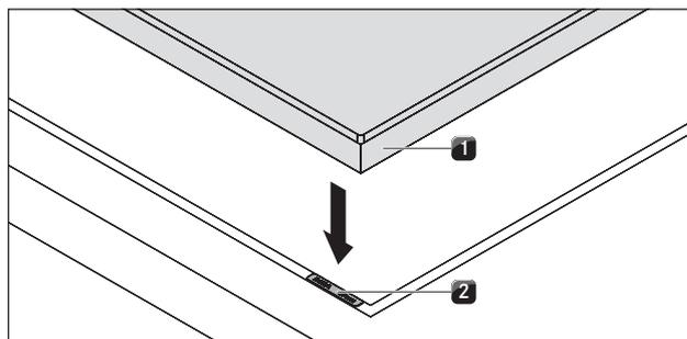
Fig. 4.29 Table de cuisson et plaques de compensation des hauteurs
