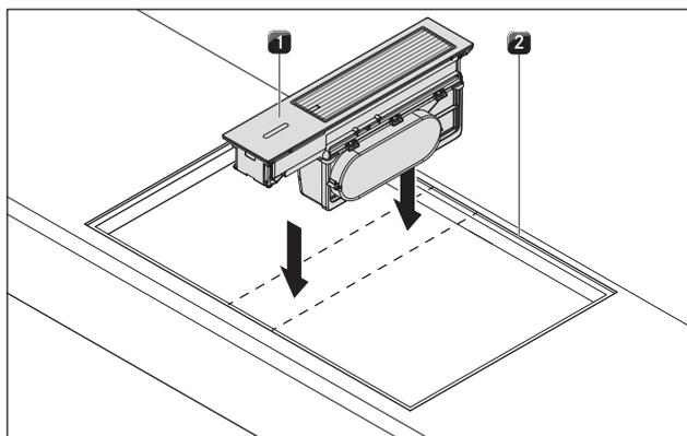
Fig. 4.23 Insertion du dispositif aspirant dans la découpe du plan de travail
