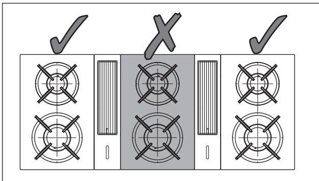
Fig. 4.5 Positionnement de CKG avec deux dispositifs aspirants
