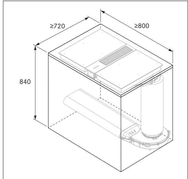
Fig. 4.15 Dimensions minimales de montage avec silencieux rond USDR50
