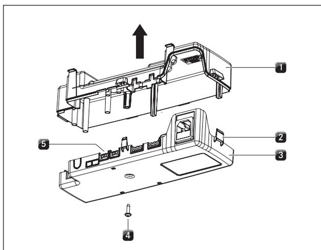
Fig. 4.33 Ouverture du boîtier de l'unité de régulation
