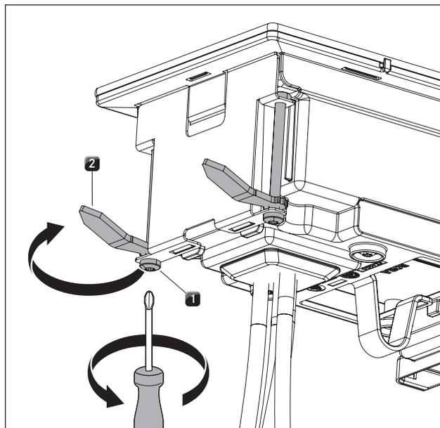
Fig. 4.30 Fixation du dispositif aspirant
