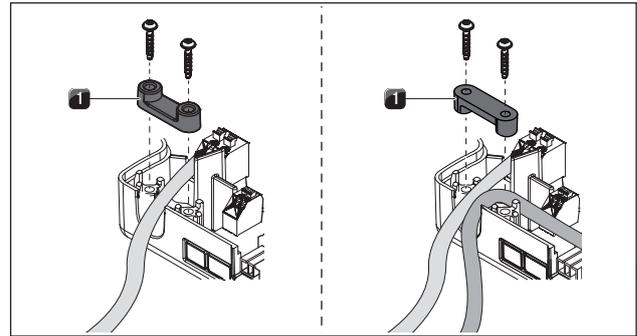
**Fig. 4.37** Montage du serre-câble
