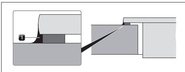
Fig. 4.50 Joint en silicone en montage en saillie
