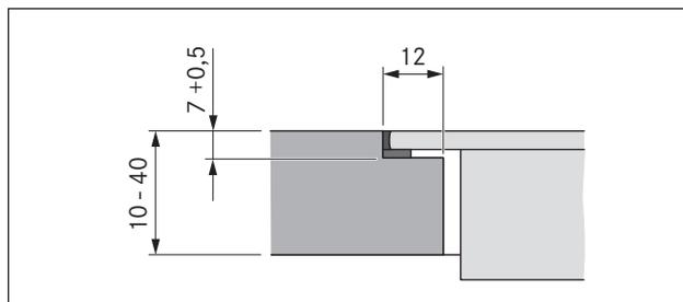
Fig. 4.11 Dimension de rainure pour montage affleurant
