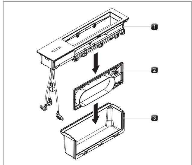
Fig. 4.22 Assemblage des composants du dispositif aspirant CKA2/CKA2AB
