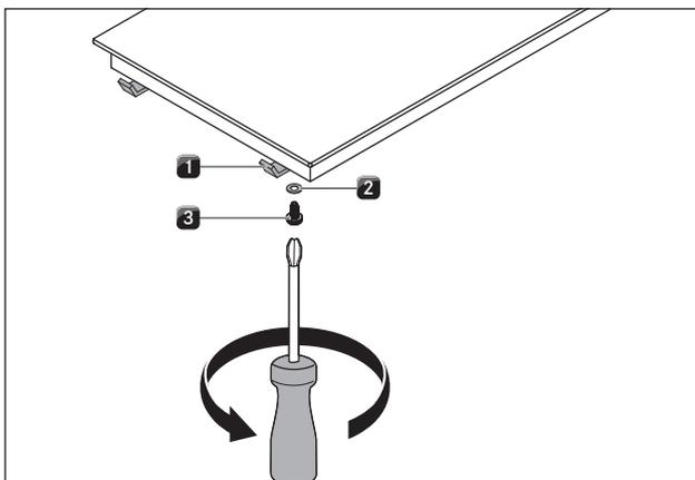
Fig. 4.31 Fixation de la table de cuisson
