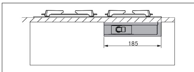
Fig. 4.8 Découpe latérale pour le raccordement du gaz
