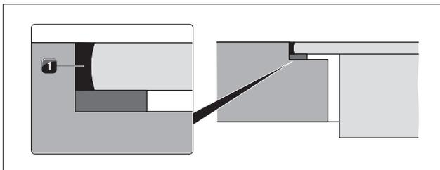
Fig. 4.49 Joint en silicone en montage affleurant
