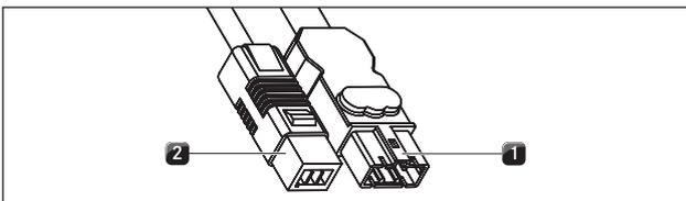
Fig. 4.43 Connecteurs du ventilateur
