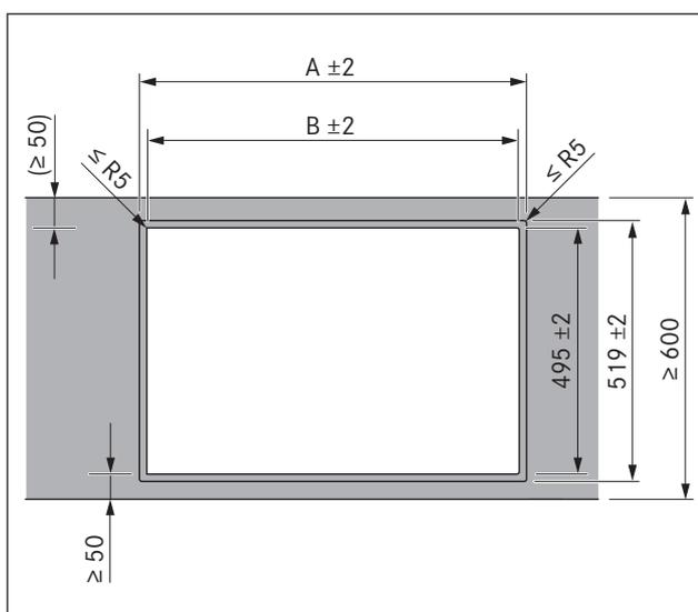
Fig. 4.10 Dimensions de découpe montage affleurant
