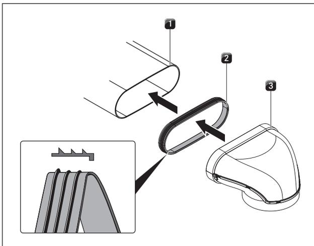
Fig. 4.26 Assemblage du système de canaux
