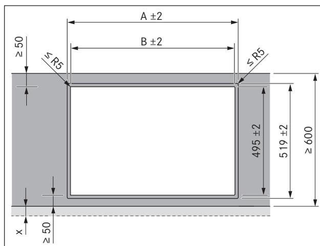
Fig. 5.3 Montaje enrasado
