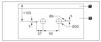
Fig. 5.10 Drilling template
