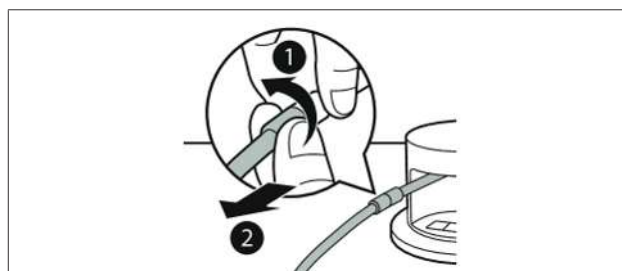
Obr. 6.3 Uvoľnenie vákuovacej hadice zo spojky
