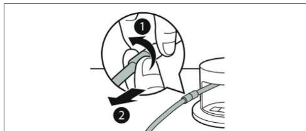
Rys. 6.3 Odtwarzanie węża do pakowania próżniowego od złącza
