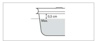
Fig. 5.4 Maximum fill level
