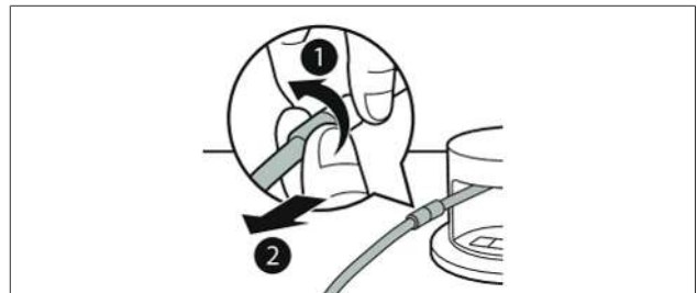
Fig. 6.3 Sådan løsnes vakuumslangen fra koblingen
