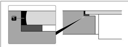
Abb. 9.43 Silikondichtmasse bei flächenbündiger Montage
