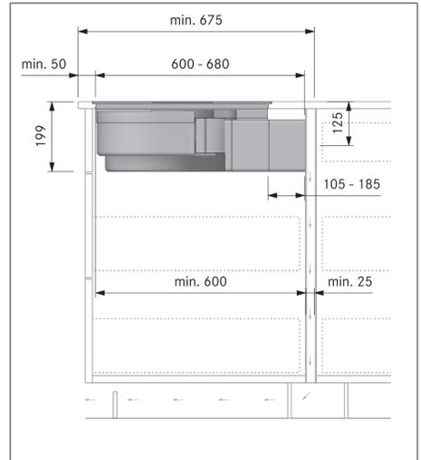
Abb. 9.26 Einbaumaße bei Umluft-Montagevariante A, Arbeitsplattentiefe ab 675 mm
