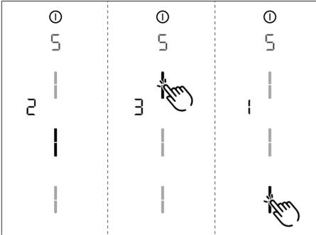
Abb. 6.5 Menüpunkt 5: Reaktionsgeschwindigkeit
