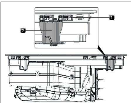
Abb. 9.25 Montageklammern anbringen
