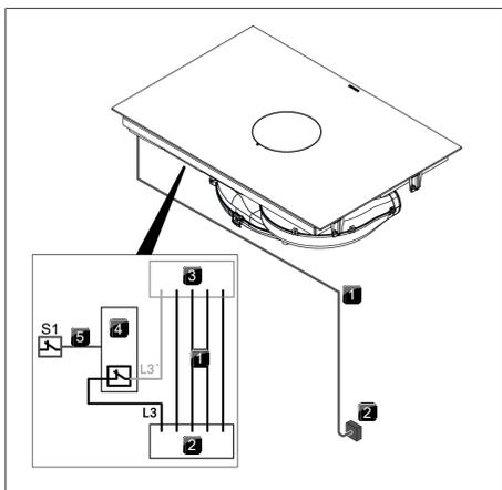
Abb. 9.33 Anschlussschema mit externem Schaltkontakt
