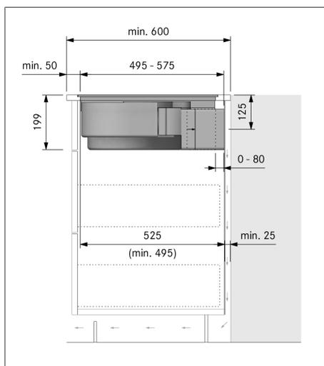
Abb. 9.21 Einbaumaße bei Umluft, Montagevariante A
