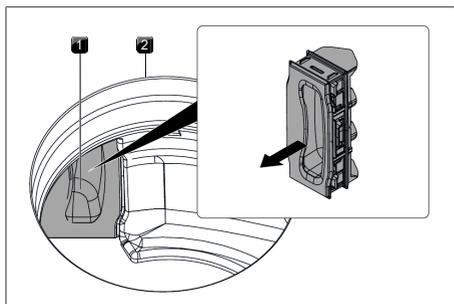
Abb. 7.4 Filterwechselklappe entfernen
