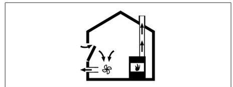
Abb. 9.2 Abluftmontage – korrekt
