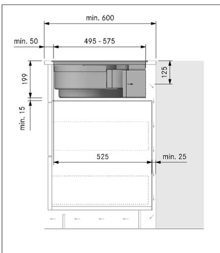
Abb. 9.22 Einbaumaße bei Umluft-Montagevariante B, Arbeitsplattentiefe 600 mm
