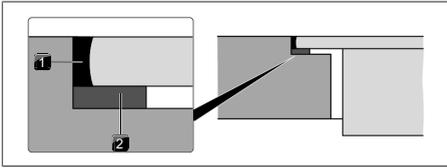
Abb. 9.11 Dichtungsband bei flächenbündiger Montage
