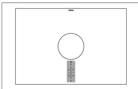
Abb. 4.4 Zentrales Touch-Bedienfeld mit Touch-Slider
