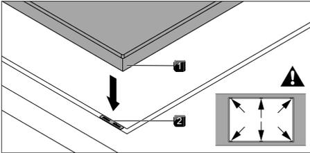
Abb. 9.29 Positionierung der Höhenausgleichsplatten
