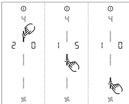
Abb. 6.4 Menüpunkt 4: Dauer der Nachlaufautomatik auswählen
