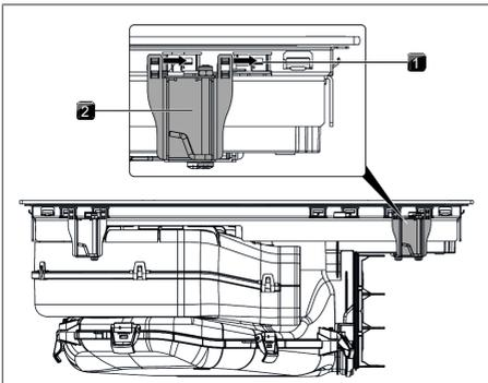
Abb. 9.12 Montageklappen anbringen
