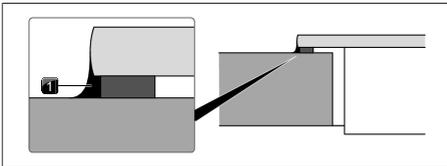
Abb. 9.42 Silikondichtmasse bei Aufsatzmontage
