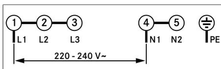
Abb. 9.35 Anschlussschema 1-Phasen-Anschluss
