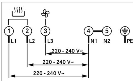
Abb. 9.34 Anschlussschema 3-Phasen-Anschluss
