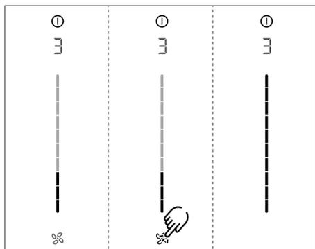
Abb. 6.3 Menüpunkt 3: Filterstand und Filterserviceanzeige zurücksetzen
