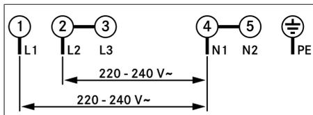
Abb. 9.36 Anschlussschema 2-Phasen-Anschluss
