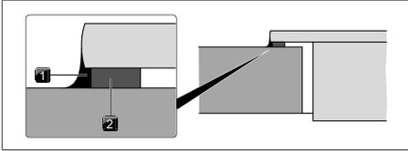
Abb. 9.23 Dichtungsband bei Aufsatzmontage
