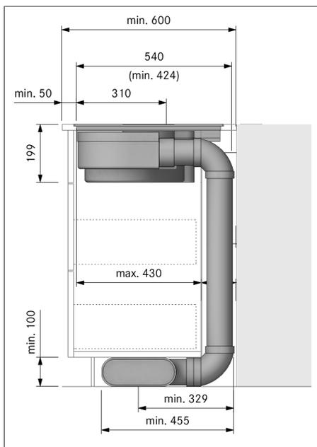
Abb. 9.9 Einbaumaße Abluft, Arbeitsplattentiefe 600 mm
