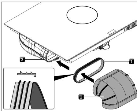
Abb. 9.17 Anschluss an Kanalsystem
