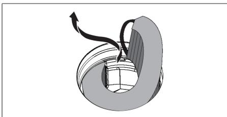
Abb. 7.6 Aktivkohlefilter aus der Einströmöffnung entnehmen
