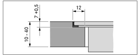
Abb. 9.6 Falzmaß für flächenbündige Montage
