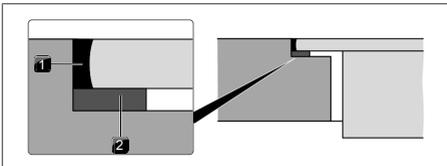
Abb. 9.24 Dichtungsband bei flächenbündiger Montage
