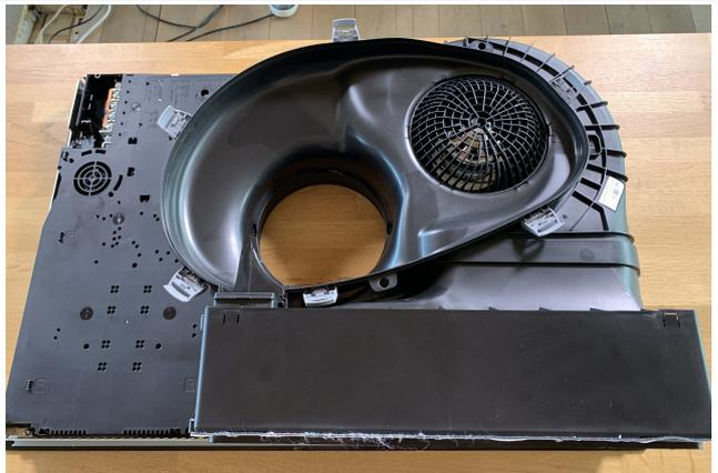
► Lösen Sie mit Hilfe eines Schlitz Schraubendrehers das Luftführungsgehäuse.
