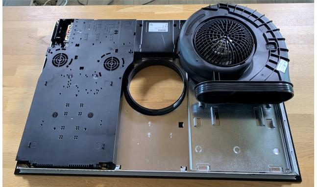
► Schrauben Sie mit Hilfe eines Torx Schraubendrehers die Elektronik-Abdeckung ab.
