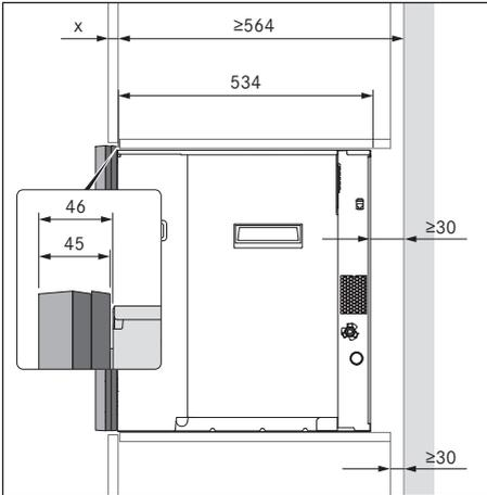
Fig. 9.5 Dimensões de instalação com 2 estruturas de espaçamento
