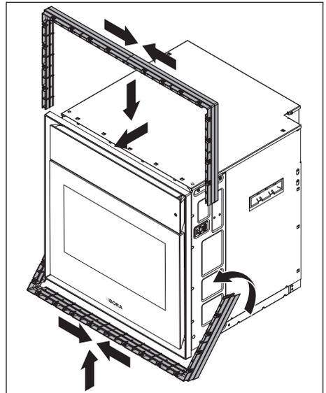
Fig. 9.8 Montagem de 2 estruturas de espaçamento
