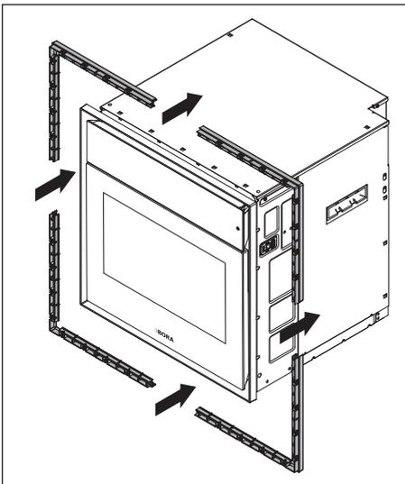
Fig. 9.6 Desmontar a estrutura de espaçamento
