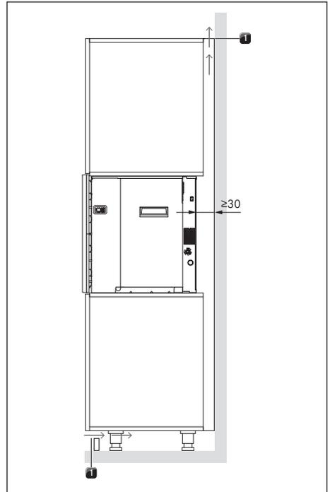
Fig. 9.16 Ventilação
