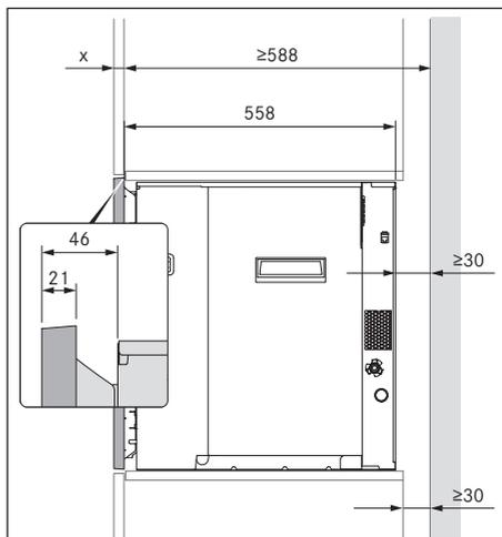
Fig. 9.3 Dimensões de instalação sem estrutura de espaçamento
