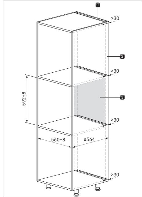
Fig. 9.1 Armoire d'encastrement
