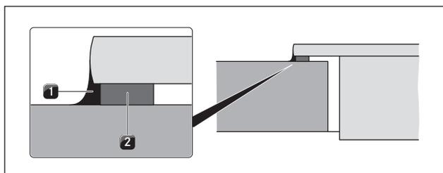
Fig. 5.11 Nastro a tenuta per montaggio in battuta
