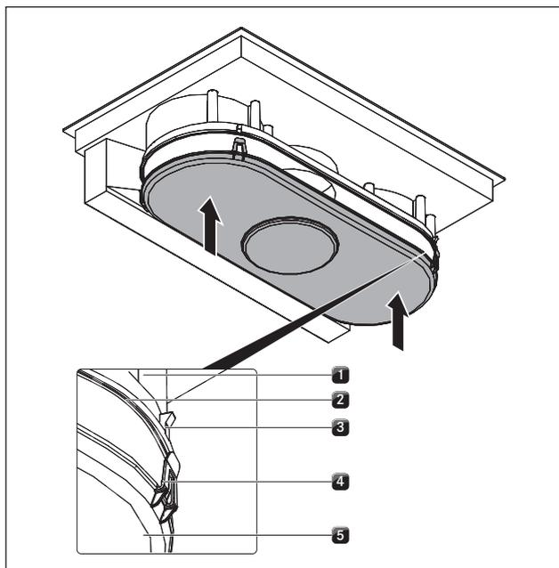
Fig. 12.4 Chiudere l'alloggiamento conduttura aria
