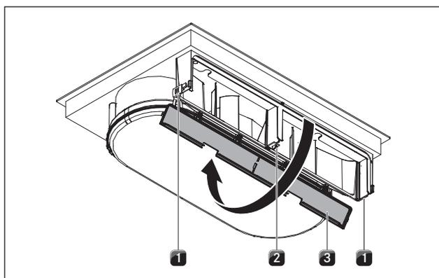
Fig. 5.13 Aprire il coperchio dell'alloggiamento
