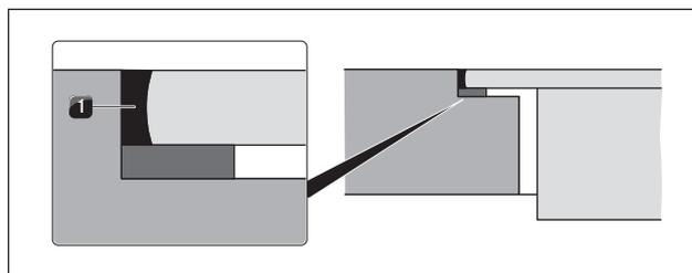
Fig. 5.26 Pasta sigillante al silicone per montaggio a filo piano
