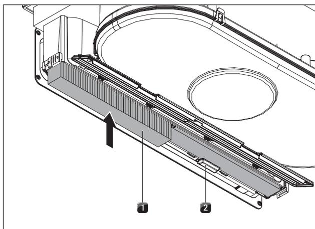
Fig. 12.9 Inserire il filtro al carbone attivo
