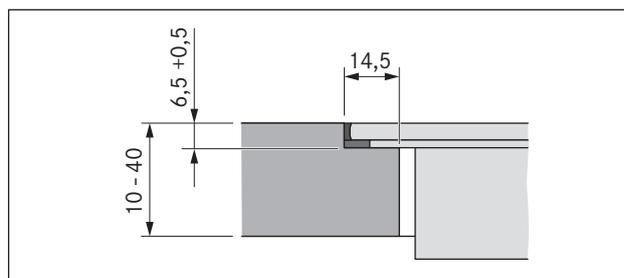
Fig. 5.8 Dimensioni dell'incassatura per montaggio a filo piano
