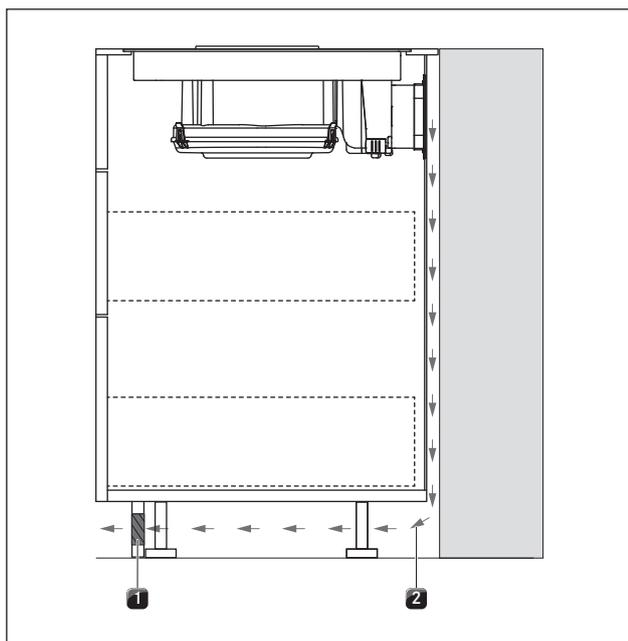
Fig. 5.3 Apertura di sfogo nell'area dello zoccolo
