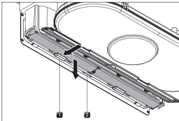
Fig. 12.8 Rimuovere il filtro al carbone attivo
