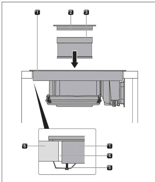
Fig. 5.19 Fissare il piano cottura nel centro
