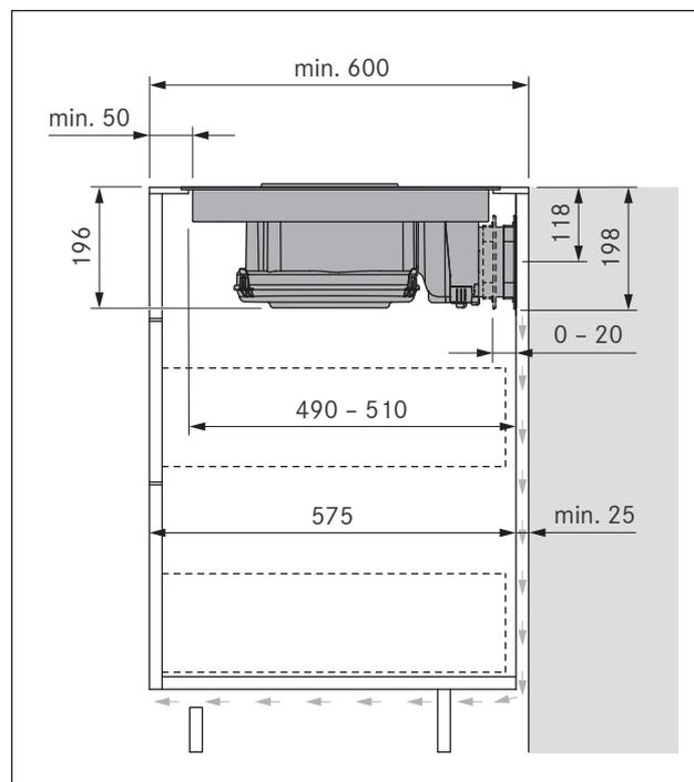
Fig. 5.4 Dimensioni d'incasso GP4U, profondità piano di lavoro 600 mm
