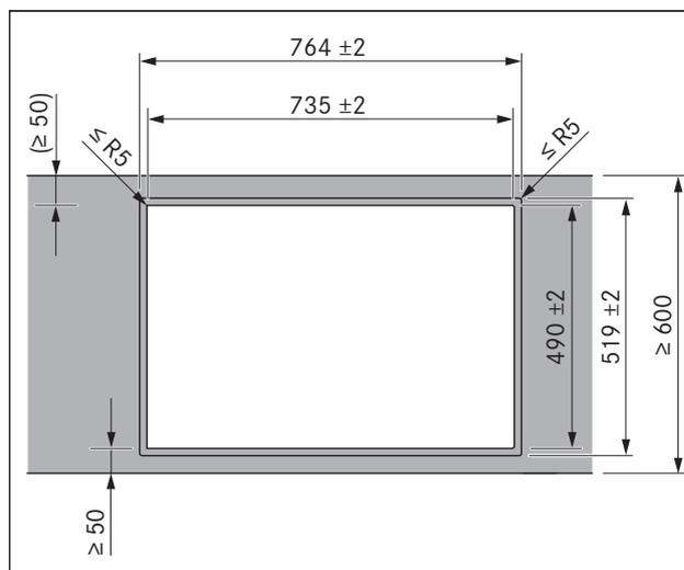
Fig. 5.7 Dimensioni intaglio per montaggio a filo piano
