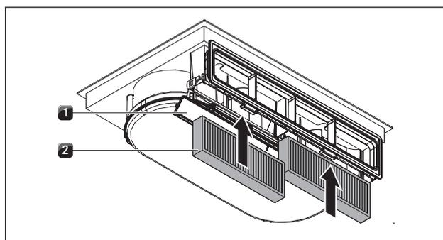
Fig. 5.15 Inserimento del filtro al carbone attivo
