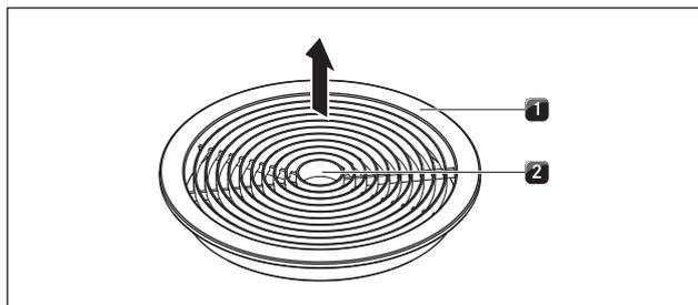
Fig. 12.1 Smontare la bocchetta d'entrata
