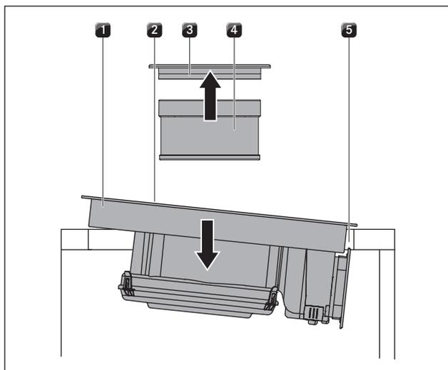
Fig. 5.16 Inserire il piano cottura
