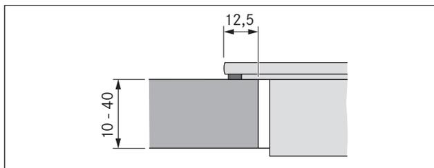
Fig. 5.10 Misura d'appoggio per montaggio in battuta
