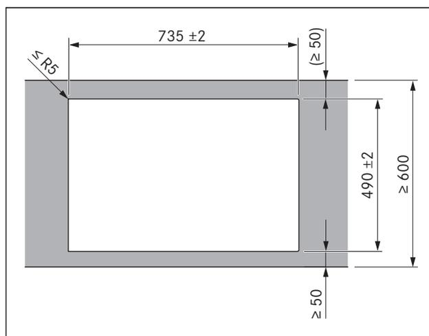
Fig. 5.9 Dimensioni intaglio per montaggio in battuta
