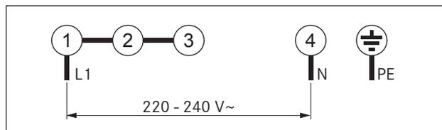
Fig. 5.23 Schema di collegamento monofase
