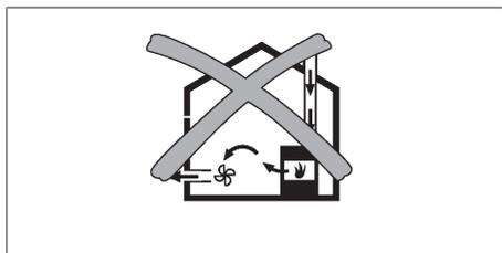
Fig. 9.1 Montaggio scarico aria – non consentito
