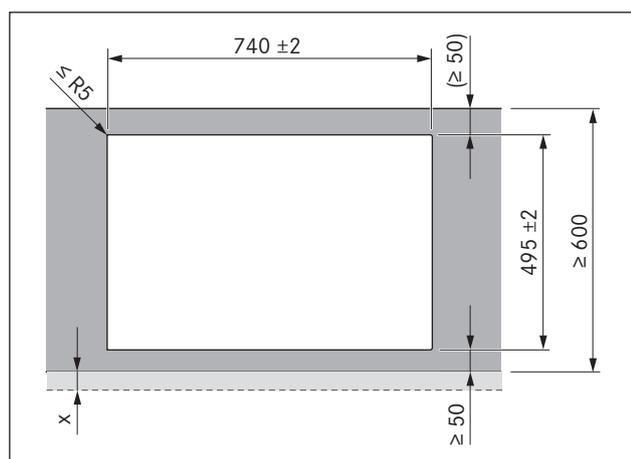
Fig. 6.13 Dimensioni d'intaglio per montaggio in battuta
