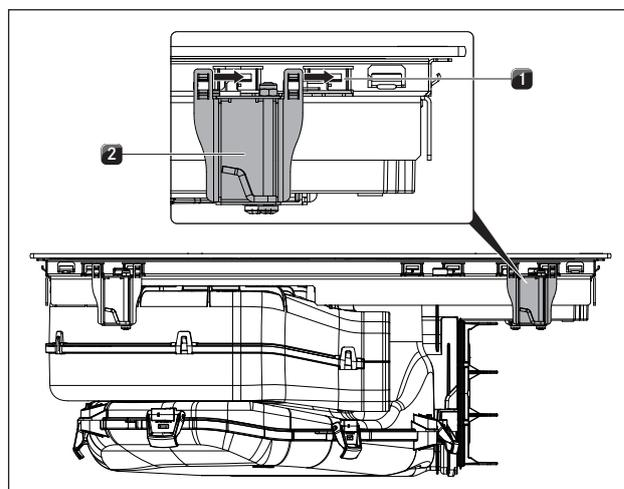
Fig. 6.33 Applicare i morsetti di montaggio
