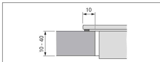
Fig. 6.14 Misura d'appoggio per montaggio in battuta
