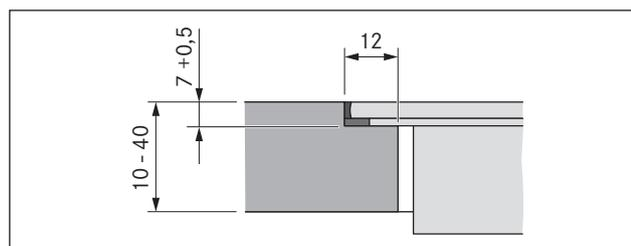
Fig. 6.12 Dimensioni dell'incassatura per montaggio a filo piano
