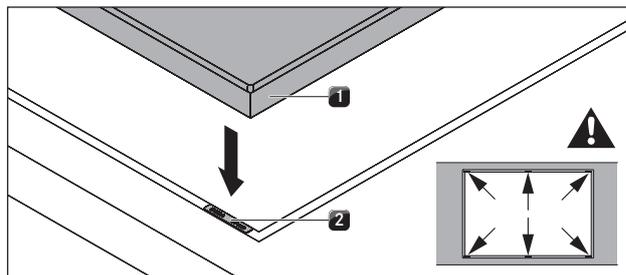
Fig. 6.37 Pannelli di compensazione altezza
