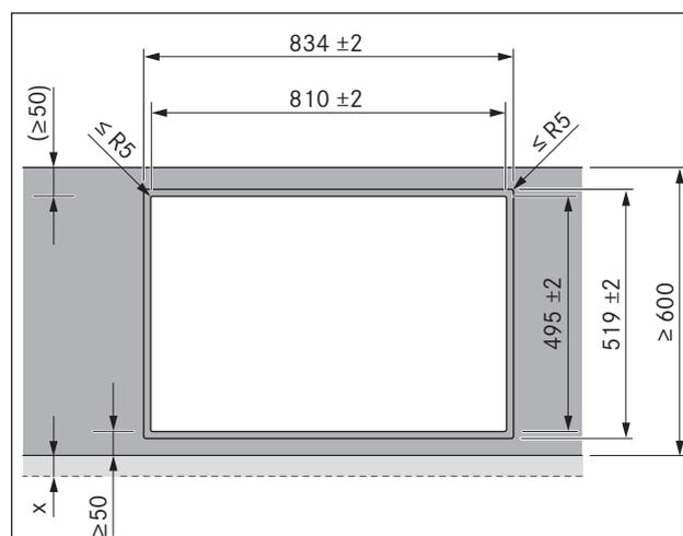
Fig. 6.7 Dimensioni d'intaglio per montaggio a filo piano
