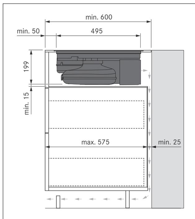
Fig. 6.30 Dimensioni di montaggio con sistema filtrante variante di montaggio B, profondità piano di lavoro 600 mm
