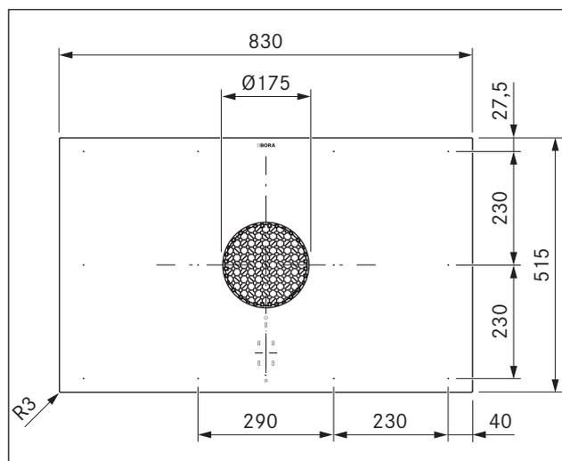
Fig. 3.4 PUXU dimensioni apparecchio visto da sopra
