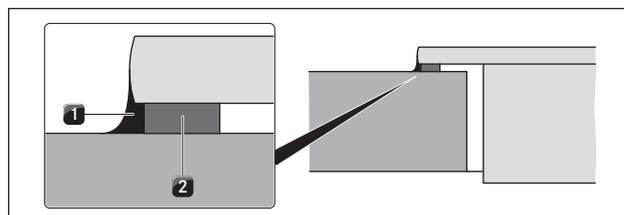
Fig. 6.16 Nastro a tenuta per montaggio in battuta
