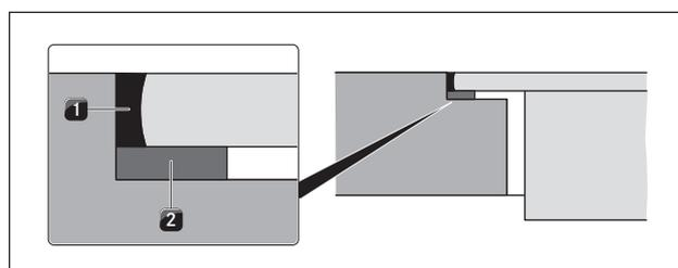
Fig. 6.32 Nastro a tenuta per montaggio a filo piano
