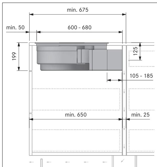
**Fig. 6.34** Dimensioni di montaggio con sistema filtrante variante di montaggio A, profondità piano di lavoro da 675 mm
