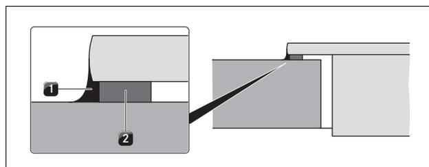
Fig. 6.31 Nastro a tenuta per montaggio in battuta
