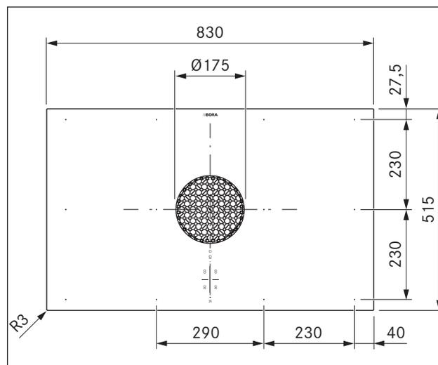
Fig. 3.1 PUXA dimensioni apparecchio visto da sopra
