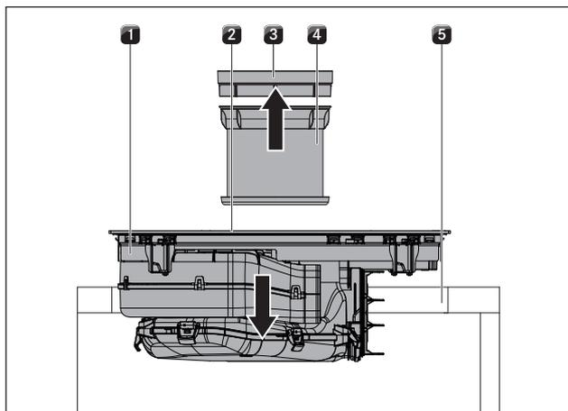
Fig. 6.19 Inserire il piano cottura
