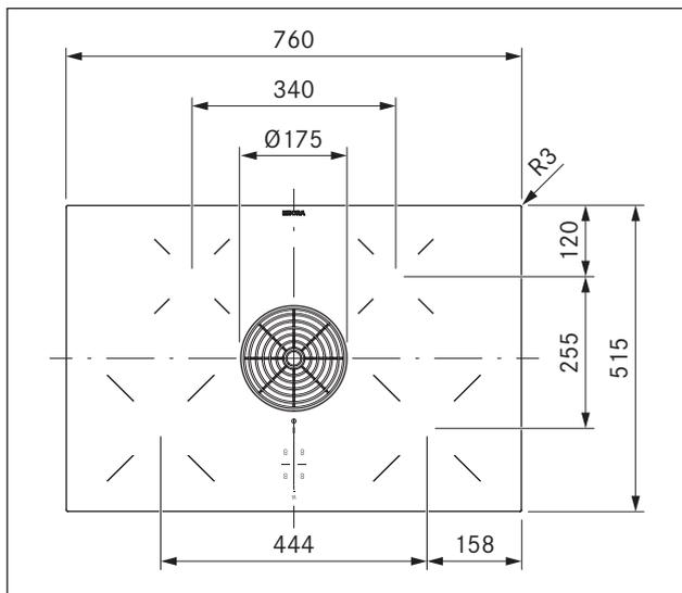
Fig. 3.7 PURA dimensioni apparecchio visto da sopra
