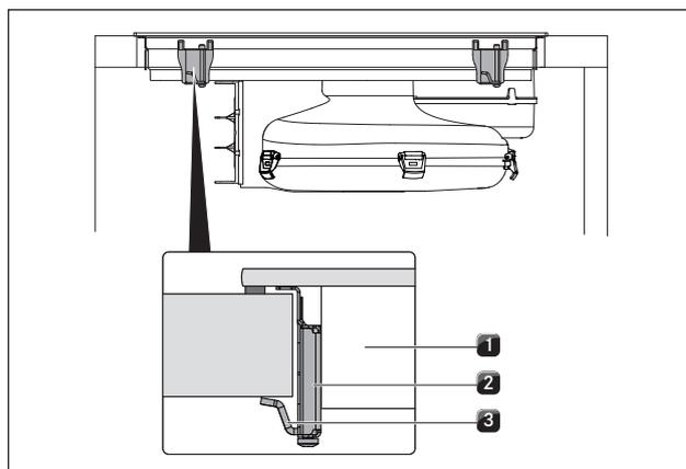
Fig. 6.39 Fissare il piano cottura
