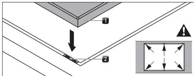
Fig. 6.20 Applicare i pannelli di compensazione altezza
