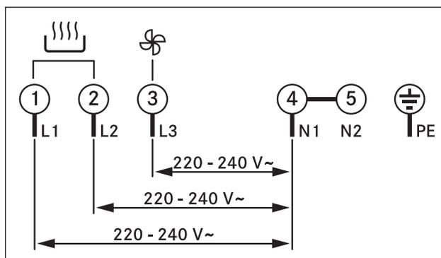
Fig. 6.47 Schema di collegamento connessione a trifase
