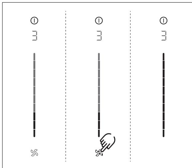
Fig. 7.4 Voce di menu 3: Visualizzare e resettare lo stato del filtro
