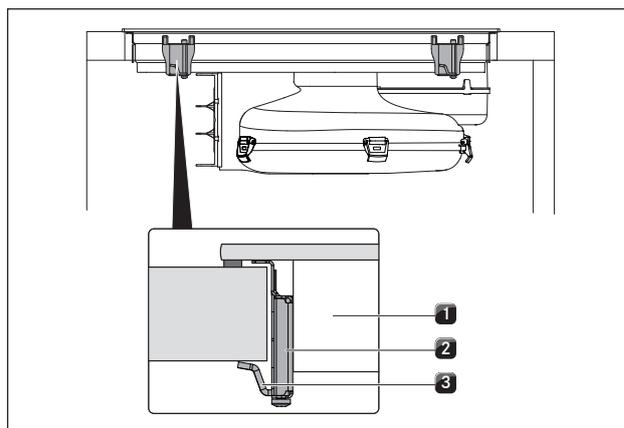
Fig. 6.22 Fissare il piano cottura nel centro
