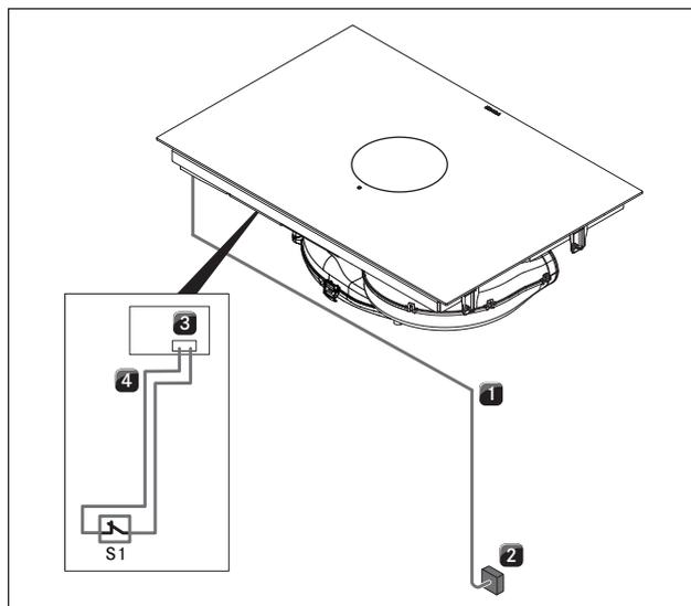
Fig. 6.46 Schema di collegamento con modulo Home-In opzionale
