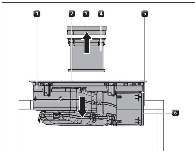
Fig. 6.36 Inserire il piano cottura nel centro
