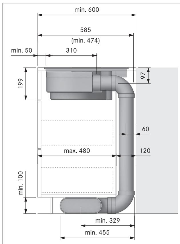
Fig. 6.15 Dimensioni di montaggio con sistema aspirante, profondità piano di lavoro 600 mm
