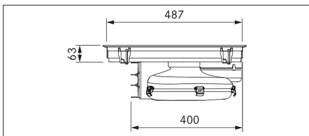
Fig. 3.9 PURA dimensioni apparecchio visto laterale
