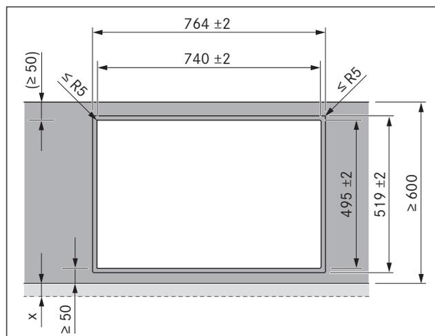
Fig. 6.11 Dimensioni d'intaglio per montaggio a filo piano
