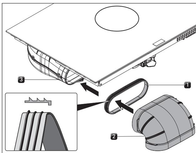
Fig. 6.23 Connessione al sistema di canali
