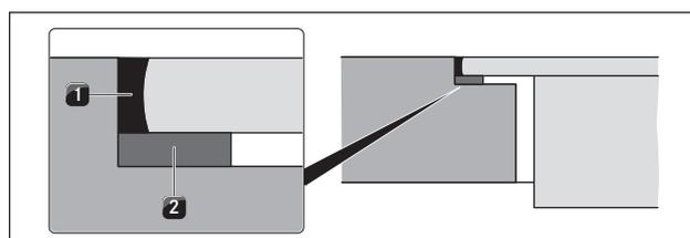
Fig. 6.17 Nastro a tenuta per montaggio a filo piano
