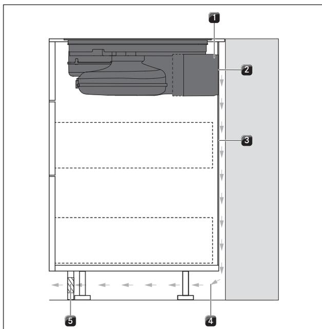
Fig. 6.25 Variante di montaggio con parete posteriore passante
