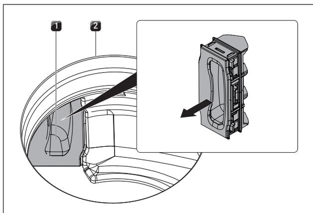
Fig. 6.41 Rimuovere la valvola di sostituzione del filtro
