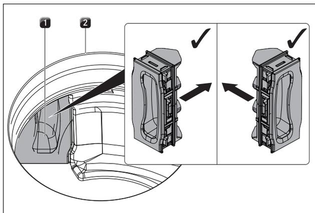
Fig. 6.45 Inserire la valvola di sostituzione del filtro
