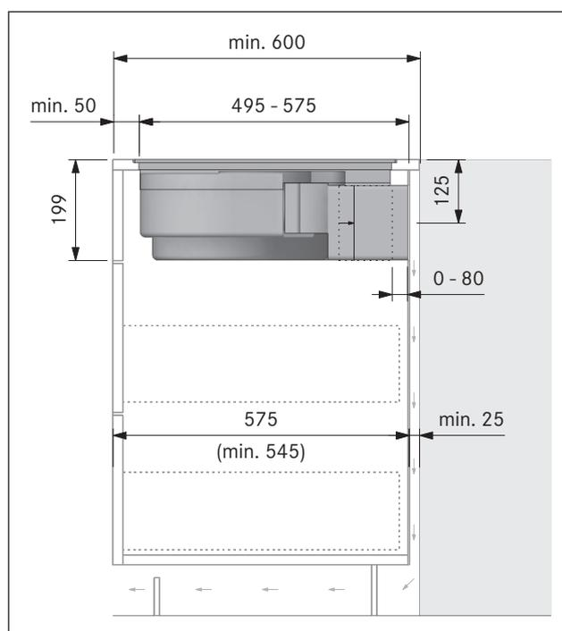
Fig. 6.27 Dimensioni di montaggio con sistema filtrante, variante di montaggio A
