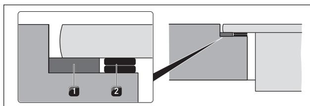
Fig. 6.38 Pannelli di compensazione altezza
