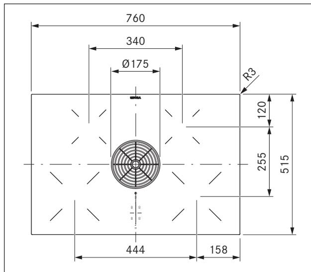
Fig. 3.10 PURU dimensioni apparecchio visto da sopra
