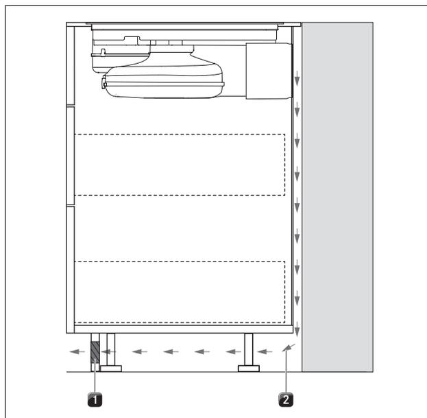
Fig. 6.24 Apertura di sfogo nell'area dello zoccolo
