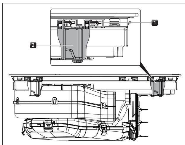
Fig. 6.18 Applicare i morsetti di montaggio
