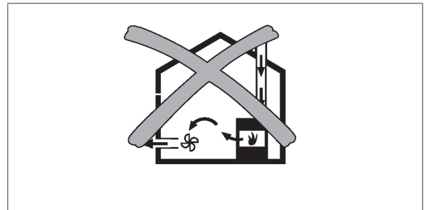
Afb. 4.1 Montage met luchtafvoer – niet toegestaan
